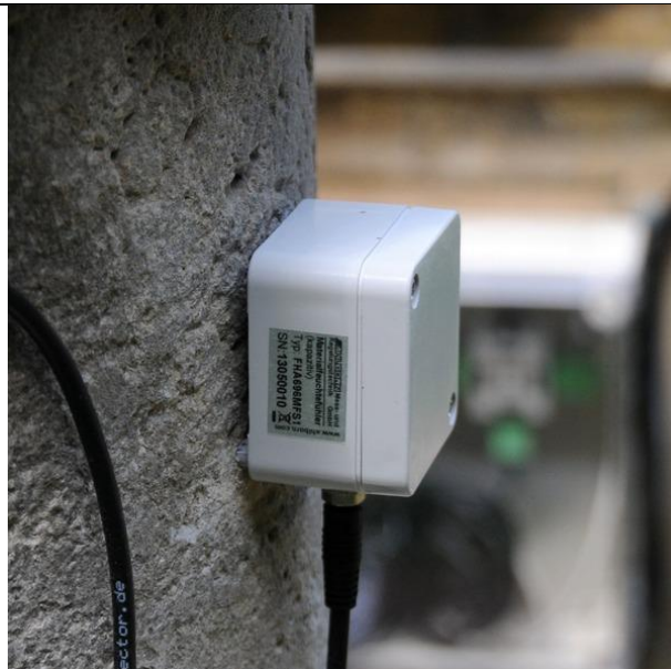
Abb. 117 Materialfeuchtefühler für stationäre Messungen - Kapazitiver Sensor zum Aufsetzen auf einer Oberfläche.
