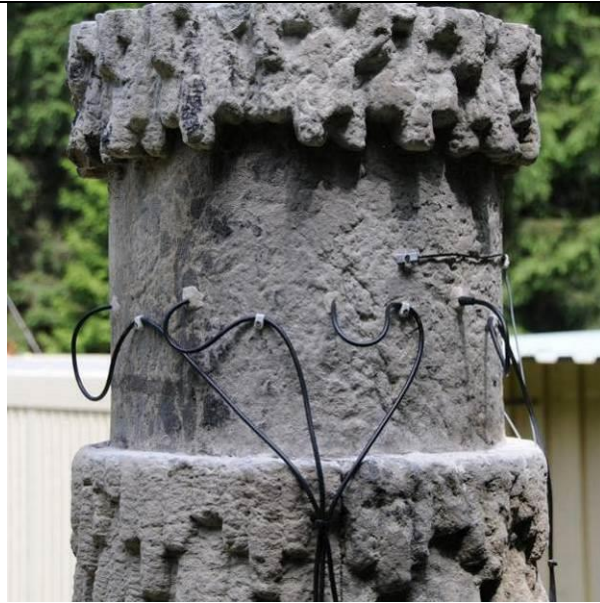
Abb. 116 Digitaler Fühler für Luftfeuchte und Temperatur
