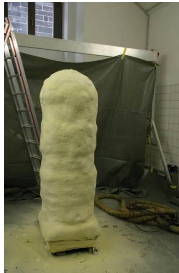
Abb. 36 Zwischenzustand der PUR-Schale
