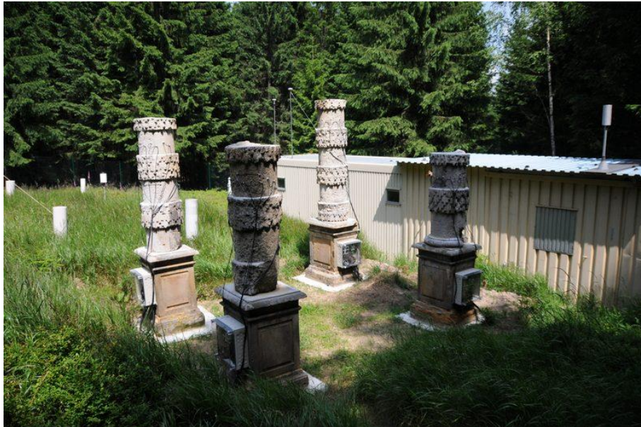
Abb. 113 Probekörper mit Messinstallation
