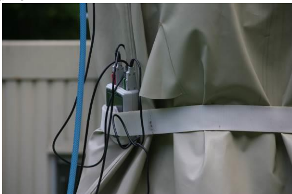
Abb. 122 Messung des Luftwechsels durch CO 2 -Abnahme unter der Textilhülle
