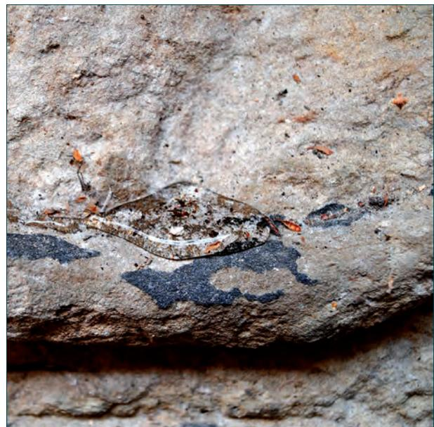
Abb. 96 Resthydrophobie auf der Oberfläche des Grabmals: Wasser „perlt“ auf der Steinoberfläche ab (nach VKV).
