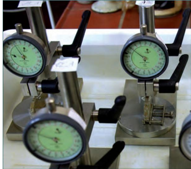
**Abb. 35** Messung der hydrischen Dehnung an Bohrkernscheiben.
