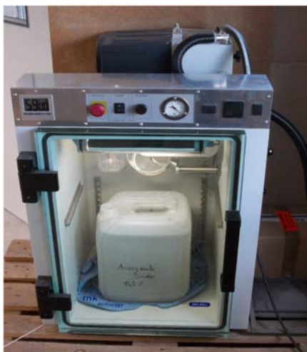
Abbildung 16: Entgasen des Binders in einer Vakuumpumpe
