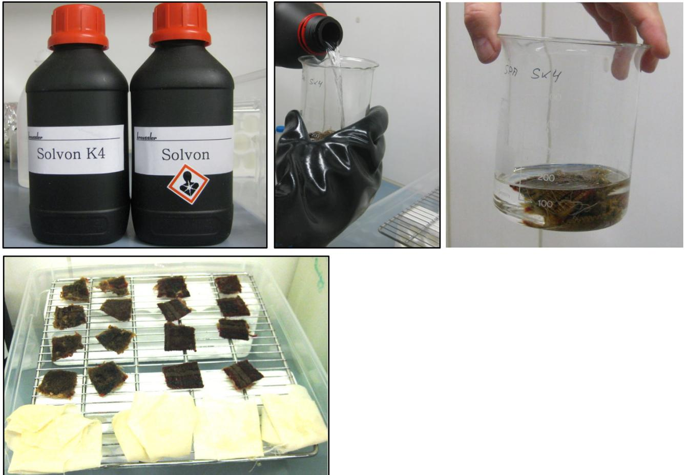
Abb. 18: Darstellung der Probenpräparation in einem Glasbecher unter ständigem Rühren (Magnetrührer) und anschließender Trocknung auf einem Gitter unter dem Laborabzug
