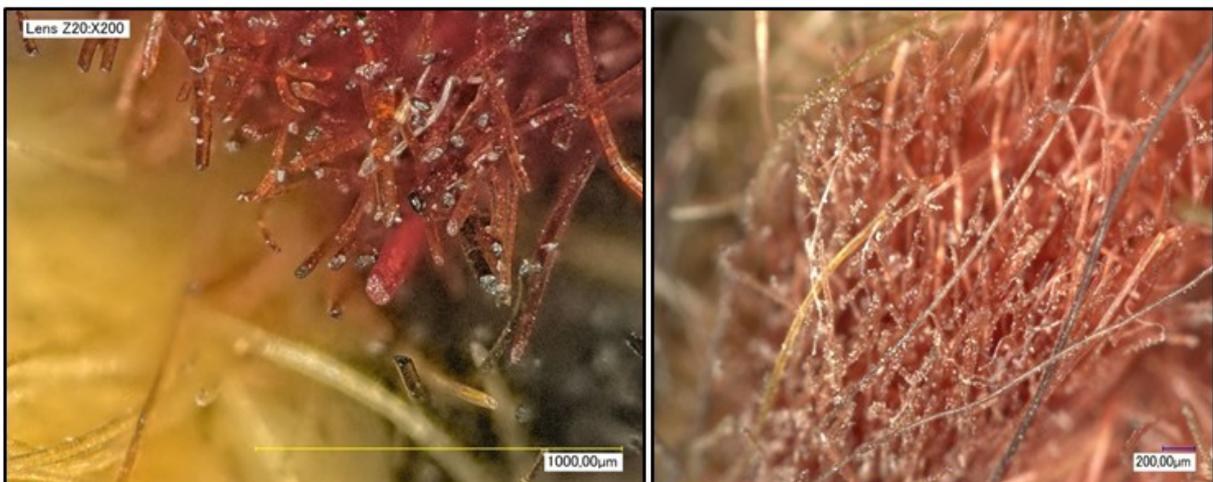
**Abb. 6: Dokumentation kristalliner Anhaftungen und starker Verschmutzungen durch Spinnennetze**
