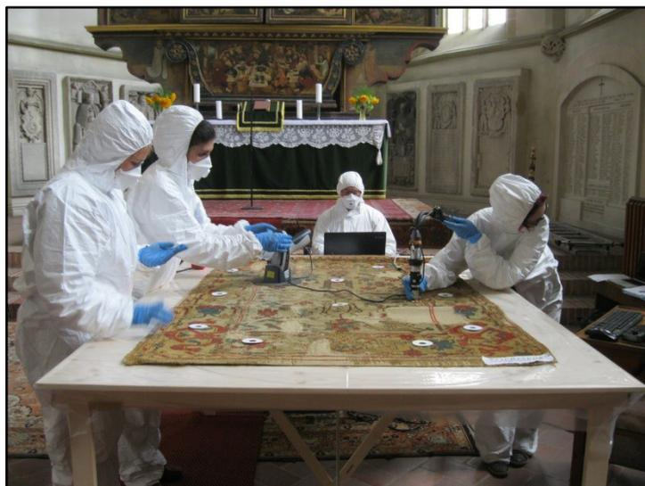
**Abb. 11: Messung mittels p-RFA (links) und Keyence (rechts)**
