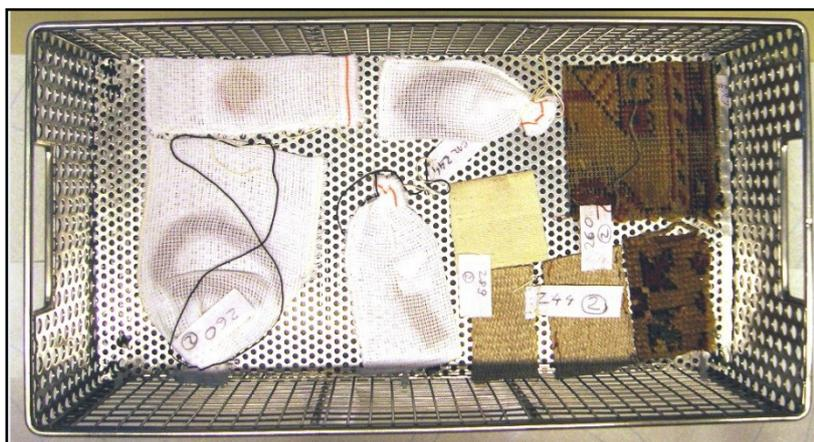
Abb. 14: Probenfragmente im „Waschkorb“ der elCO<sub>2</sub>-Anlage
