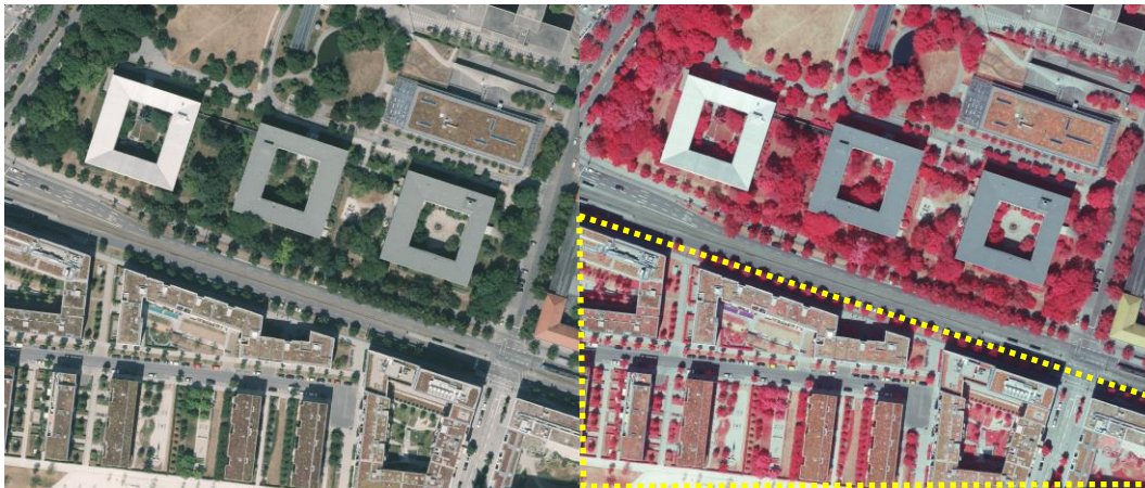
Abb. 2: Echtfarben- und Falschfarben-Luftbildaufnahmen: Vergleich RGB-Echtfarbenbild links (Rotkanal = rot, Grünkanal = grün, Blaukanal = blau) und IRG-Falschfarbenbild rechts (Rotkanal = nahes Infrarot, Grünkanal = rot, Blaukanal = grün) (© Stadt München)
