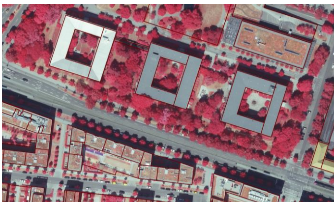
Abb. 4: Verschneidung Luftbilddaten und Hausumringe: Überlagerung der Informationen des Falschfarbeninfrarot-Luftbildes (Rotkanal = nahes Infrarot, Grünkanal = rot, Blaukanal = grün) mit den Hausumringen (rot) aus dem Katasterdatensatz. (© Stadt München/DLR)
