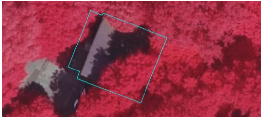
Abb. 7: Potentielle Fehlerquelle Überschimmung: Beispiel eines starken Baumüberhangs über ein Flachdach. Das Vegetationssignal der Baumkronen wird bei der Berechnung der begrünter Dachfläche nicht berücksichtigt. (© Stadt München)
