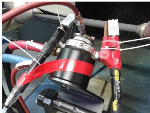
**Abbildung 3: Kühldüsen befestigt an Plasmabrenner**
