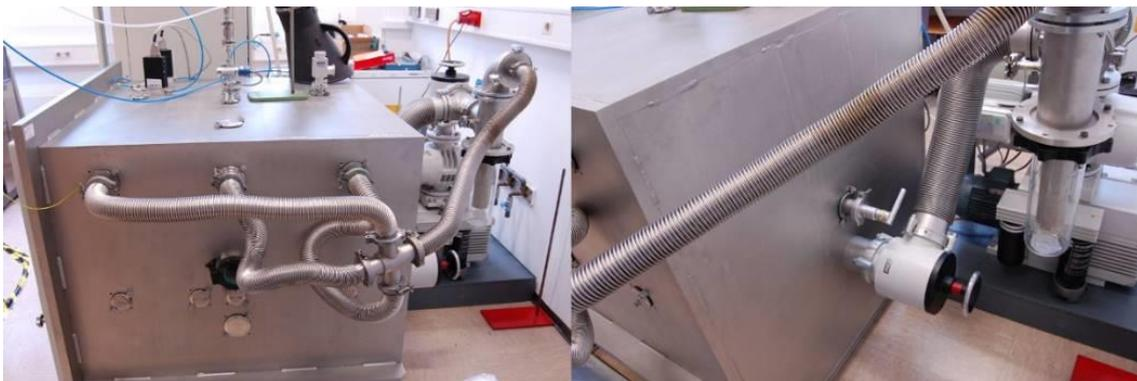
Abbildung 35: links: Gasabsaugung des Prozessgases während des Prozesses, rechts: Absaugung zur Schnelleвакуierung der Kammer.
