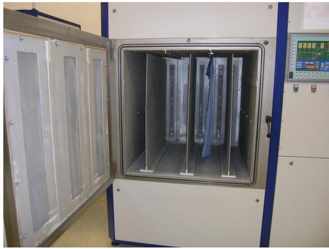
Abbildung 17: PORTA-Anlage mit speziellen HF-Elektroden
