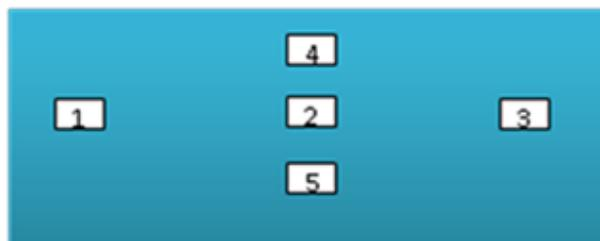
Abbildung 41: Positionierung der Wafer im Rotationsexperiment.
