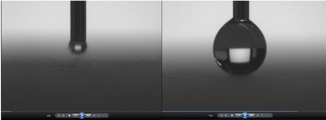
Abbildung 3: Vergleichende Kontaktwinkelmessung am unbeschichteten (links, 0 °) und beschichteten (rechts, > 150 °) Textil
