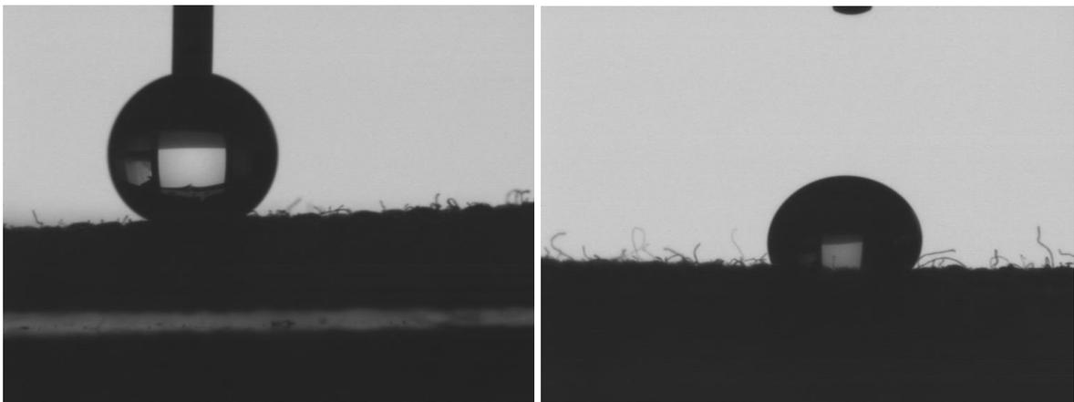
Abbildung 20: Wasser- (links) und Diiodmethan- (rechts) – Benetzung der optimierten  $C_3F_6$ -Schicht
