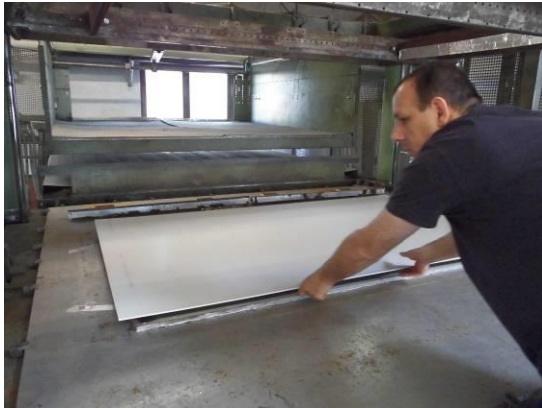
Abbildung 3: Einlegen des Zuschnitts in die Tiefziehmaschine
