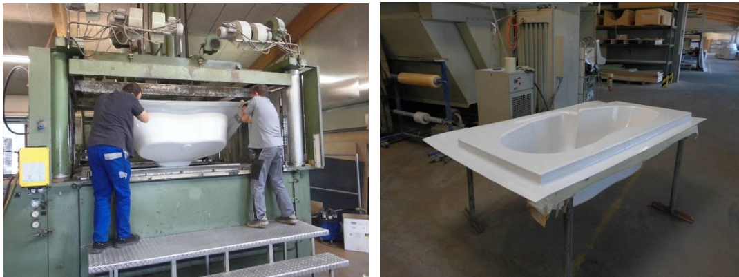
Abbildung 6: links Entformung; rechts entformtes Produkt
