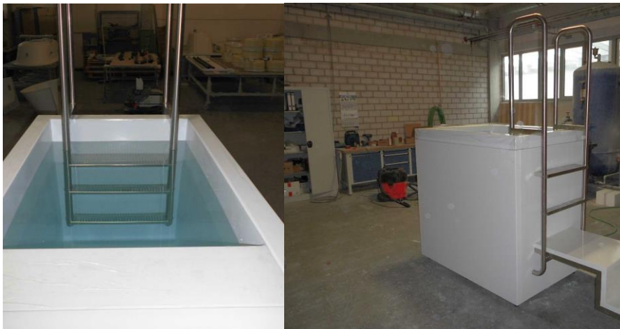
Abbildung 9: Tauchbeckenprototyp mit der neuen Gelcoatapplikation
