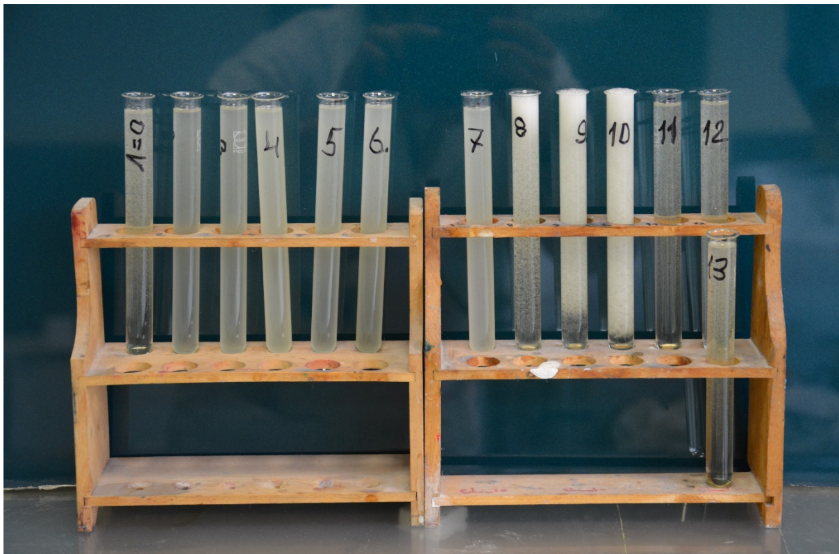
Abbildung 9: Versuchsreihe von unterschiedlichen Entlüfteradditiven in einem styrolfreien Basisharz.
