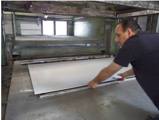
Abbildung 3: Einlegen des Zuschnitts in die Tiefziehmaschine
