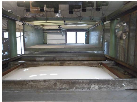
Abbildung 4: Ober- und Unterheizung wird über eingelegter Acrylplatte positioniert
