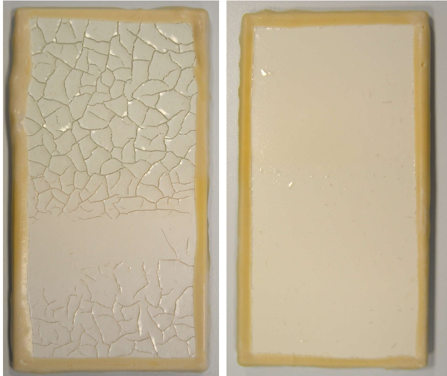
Abbildung 12: Beispiele für Schadbilder nach 1500h im Osmosetest. Links: Starke Rissbildung oberhalb und unterhalb der Wasseroberfläche. Rechts: Bildung kurzer Risse unterhalb der Wasserlinie
