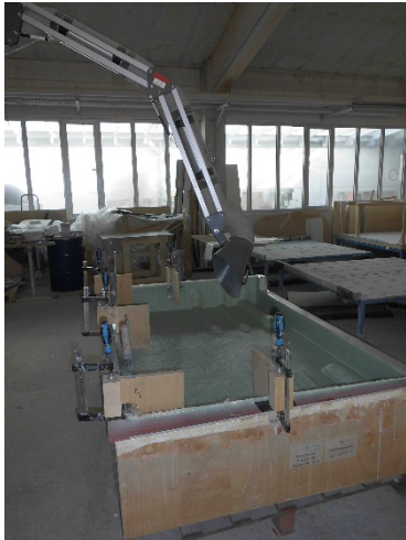
Absaugrüssel für Handlaminararbeitsplatz
