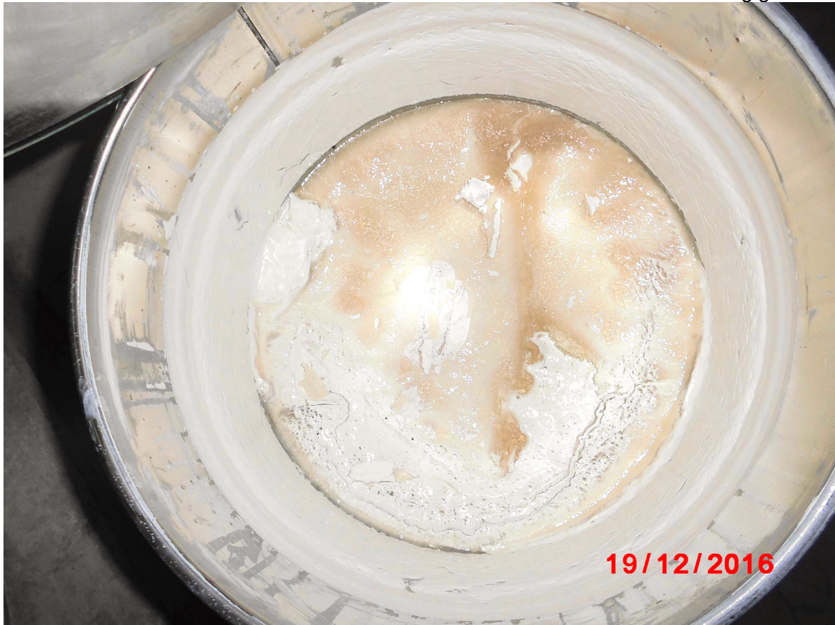
Abbildung 10: Labormuster eines styrolfreien Gelcoats nach 6 Monaten Lagerung bei formatherm.
