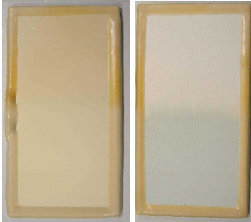
Abbildung 13: Beispiele für Schadbilder nach 1500h im Osmosetest. Links: Starkes Vergilben und Verdunkeln vor allem oberhalb der Wasserlinie. Rechts: Starkes Vergrünen unterhalb der Wasserlinie
