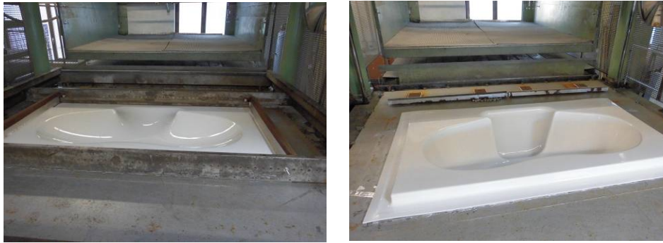
Abbildung 5: links Tiefziehprozess; rechts tiefgezogenes Produkt
