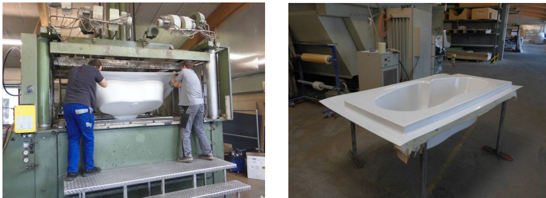
Abbildung 6: links Entformung; rechts entformtes Produkt
