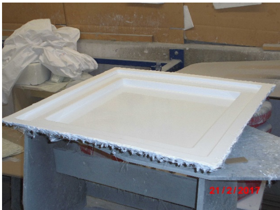
Bauteil im Spritzverfahren verstärkt
