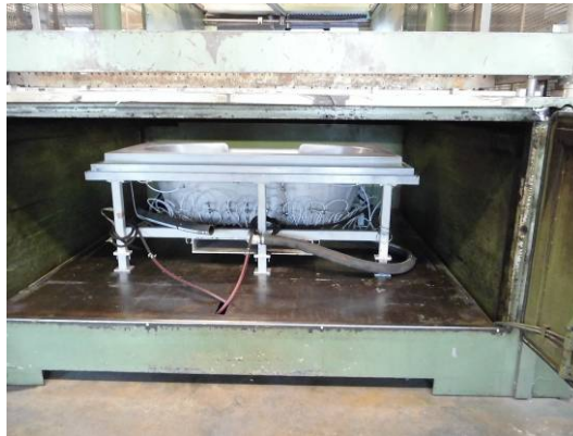
Abbildung 1: Einbau der Aluminiumform in der Tiefziehmaschine
