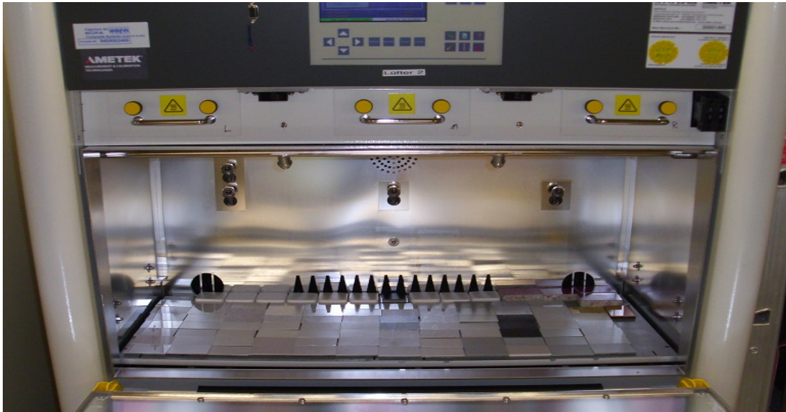
Abbildung 14: Proben in der künstlichen Bewitterung
