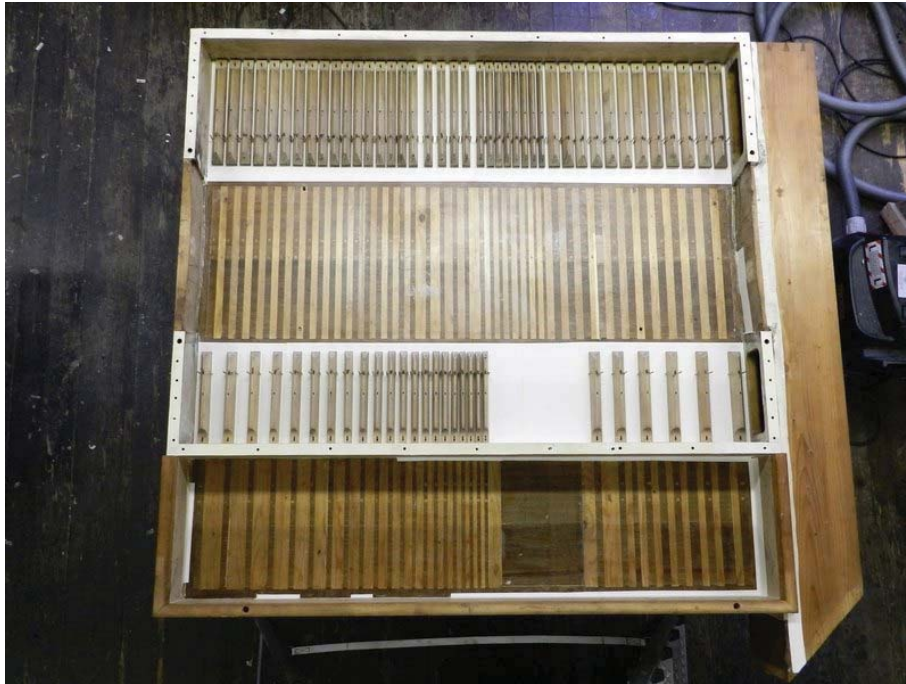
Abb. 22 Unterseite Manuawindlade mit erneuerter Papierung im Ventilauflagebereich, Pergamentierung der Bereiche außerhalb der Windkästen
