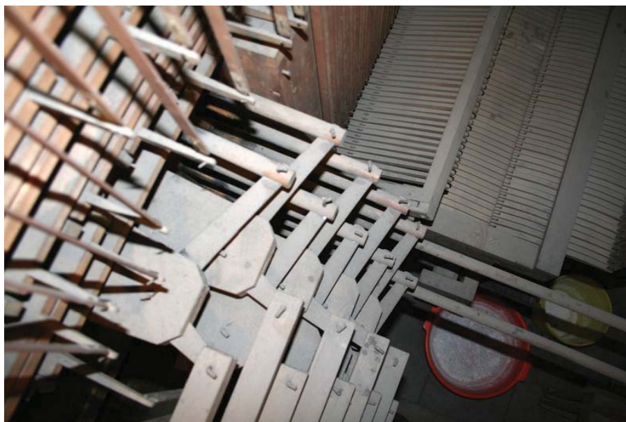
Abb. 35 Registermechanikwinkel vor der Restaurierung
