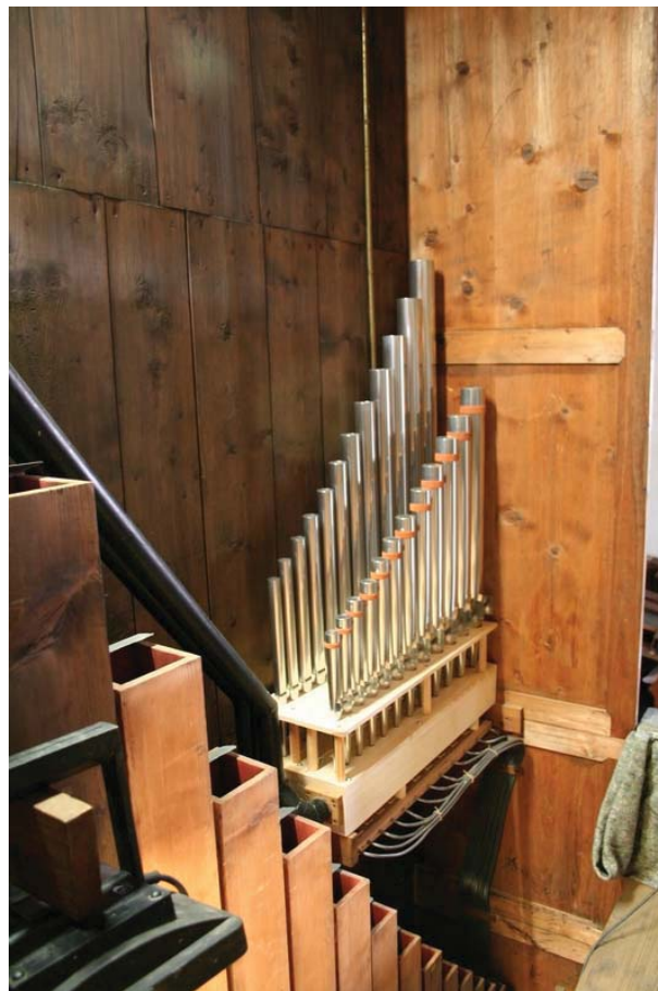
Abb. 25 Rekonstruierte pneumatische Zusatzlade D-Seite
