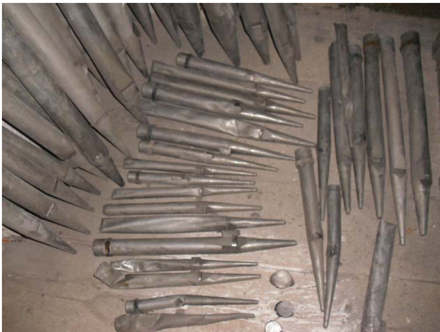
Abb. 57 Mischbestand Pfeifenfund ehemalige Besetzung pneumatischer Zusatzladen
