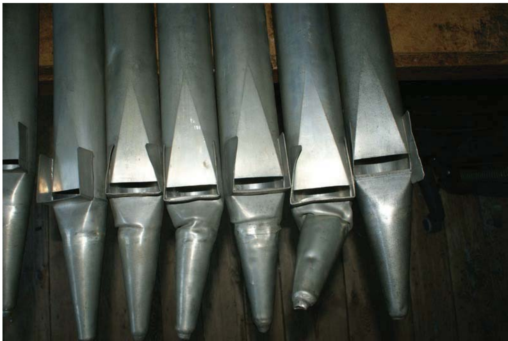
Abb. 59 Flöte 8' Pfeifen in vorgefundem Zustand, rechts außen eine Fugara Pfeife
