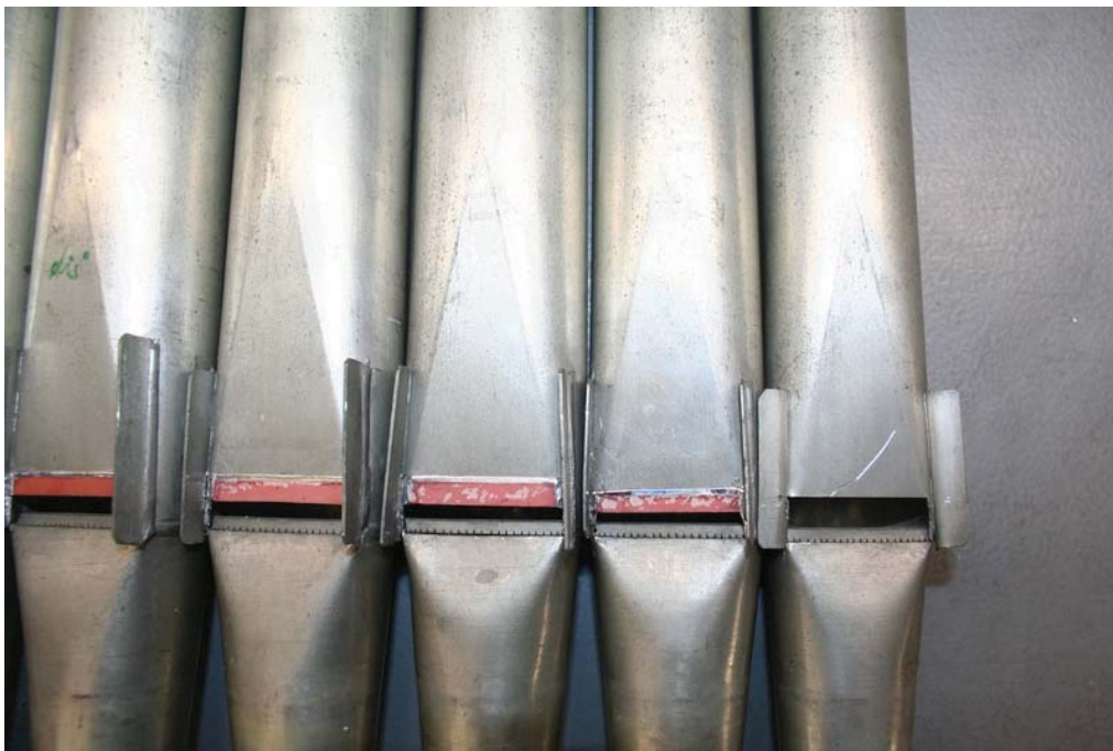
Abb. 63 Flöte 8' mit reduzierten Aufschnitten und g° mit vorgefundem Aufschnitt
