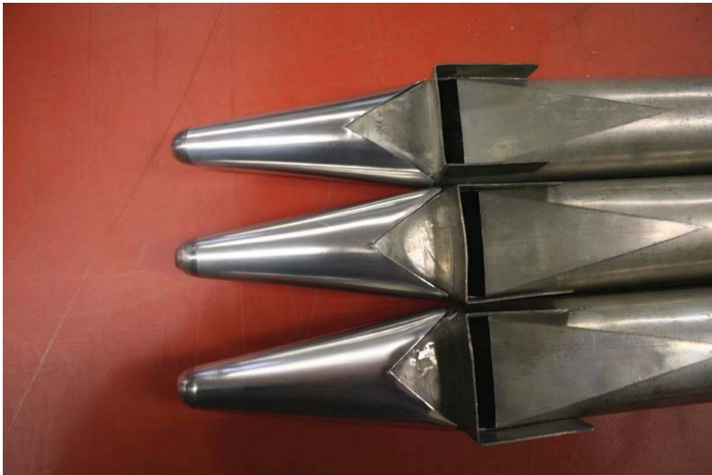
Abb. 62 Flöte C,Cs,D nach Restaurierung mit übergestülpten Fußkappen zur Stabilisierung der dünnen Wandungen
