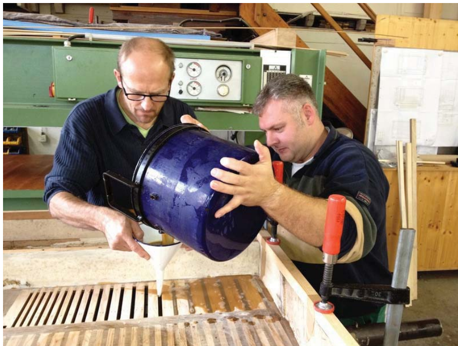
Abb. 21 Ausgießen von Kanzellen mit Warmleim
