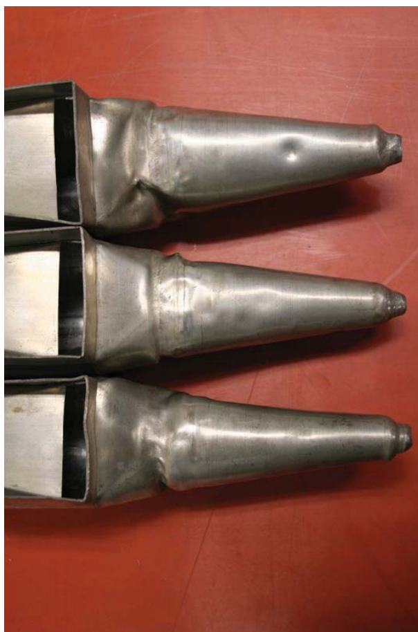
Abb. 60 Flöte 8' C,Cis,D mit deformierten Füßen im Bänkchen- und Fußspitzenbereich
