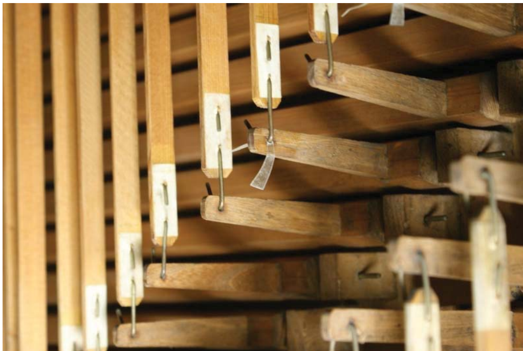
Abb. 30 Pergamentkeil zur Reduzierung des Lagespiels der Abstrakteneinbindung, Pergamentkeil im Bearbeitungszustand noch nicht angeleimt und nicht gekürzt
