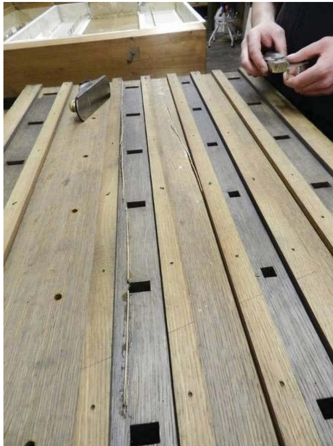
Abb. 20 Rissbeseitigung in Schleifenbahnen Pedalwindlade
