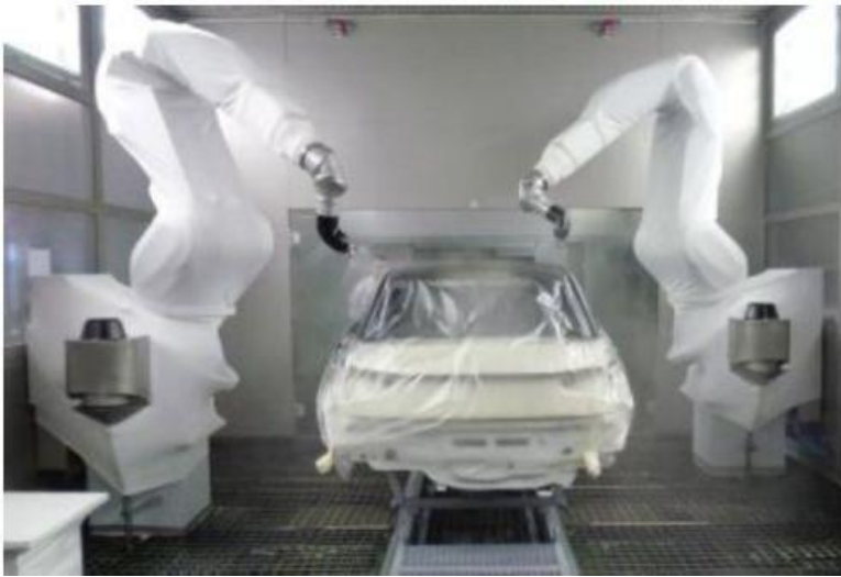
Abbildung 2: Herkömmlicher Mehrfarblackierprozess in einer Lackieranlage
