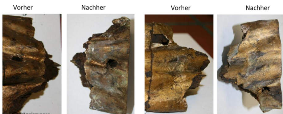
Abb. 75: fotografische Aufnahmen zum Vergleich der Fassungsfläche vor und nach der Behandlung mit dem Kompressenmaterial Aerosil HK 125 und Siedegrenzbenzin (100 – 140 °C) an GZ_VI (49 x 76 x 50 mm 3 ).
