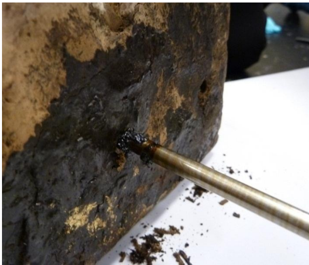
Abb. 39: Heraustropfen des Carbolineums beim Bohren an der Assistenzfigur.
