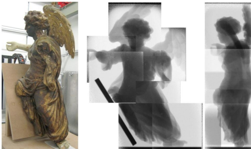
Abb. 18: Durchstrahlung der Engelsfigur mit Neutronen.
