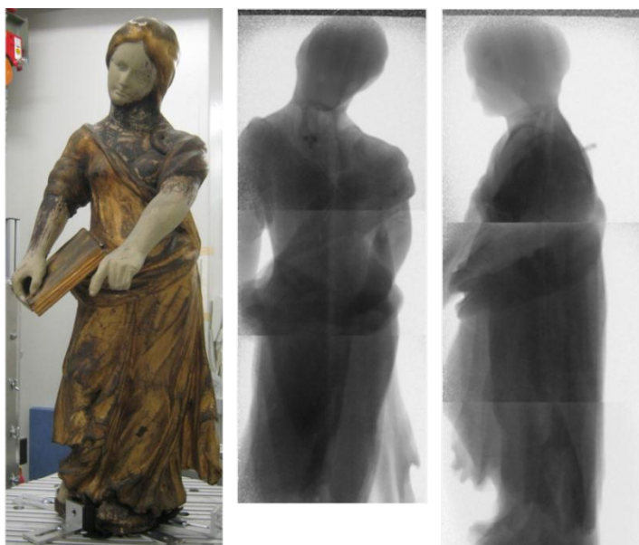
Abb. 16: Neutronenradiographie der Assistenzfigur.
