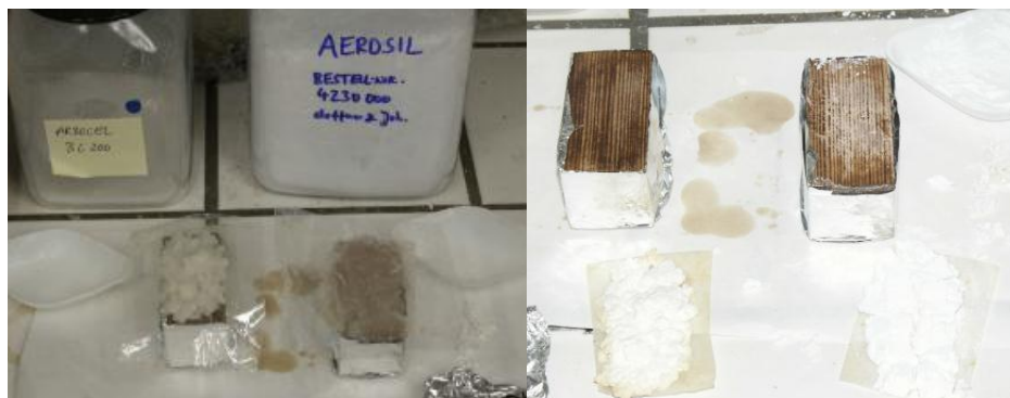
Abb. 80: Das Kompressenmaterial in Folie gewickelt (links) sowie Mock-ups nach Abnahme des jeweiligen Kompressenmaterials (rechts).
