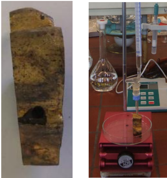
Abb. 59: Bohrloch an einem Originalfragment (links) und der Versuchsaufbau zur Diffusion (rechts).
