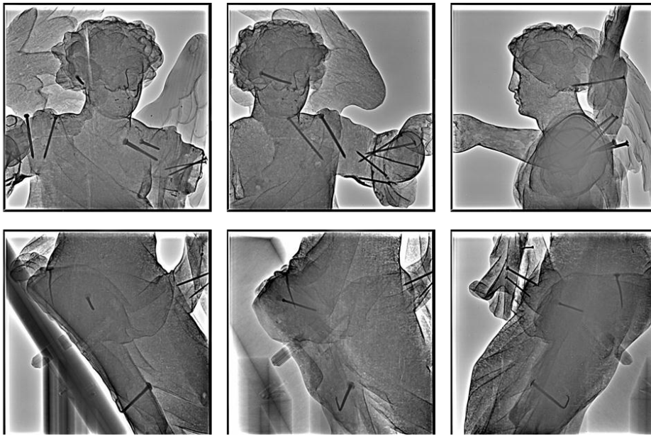
Abb. 19: Röntgenradiographie (mit Bandpassfilter bearbeitet) der Engelsfigur aus verschiedenen Richtungen.
