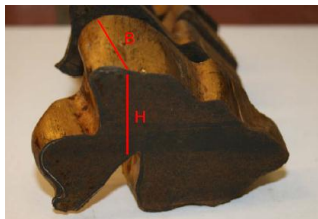
Abb. 108: Lokalisierung der Ultraschallgeschwindigkeitsmessungen.
