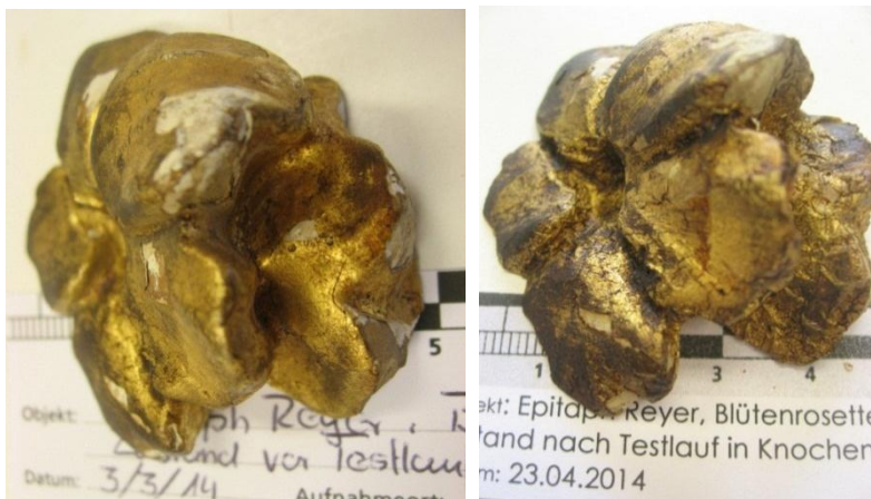
Abb. 66: Zustand der Blütenrosette (5 x 4 x 1 cm 3 ) vor (links) und nach (rechts) der Dampfphasen-Extraktion mit Dichlormethan in der Knochenentfettungsanlage.
