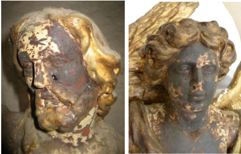
Abb. 2: Schadensbild durch Carbolineumpenetration an der Figur des Salvators und des Engels.
