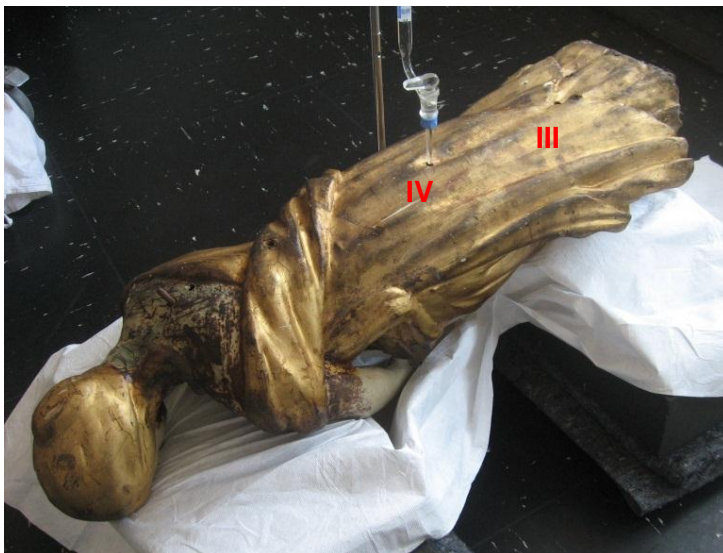
Abb. 57: Versuchsaufbau für die Lösungsmittelpenetration quer zur Faserrichtung an der Assistenzfigur mit den Bohrlöchern III bzw. IV.
