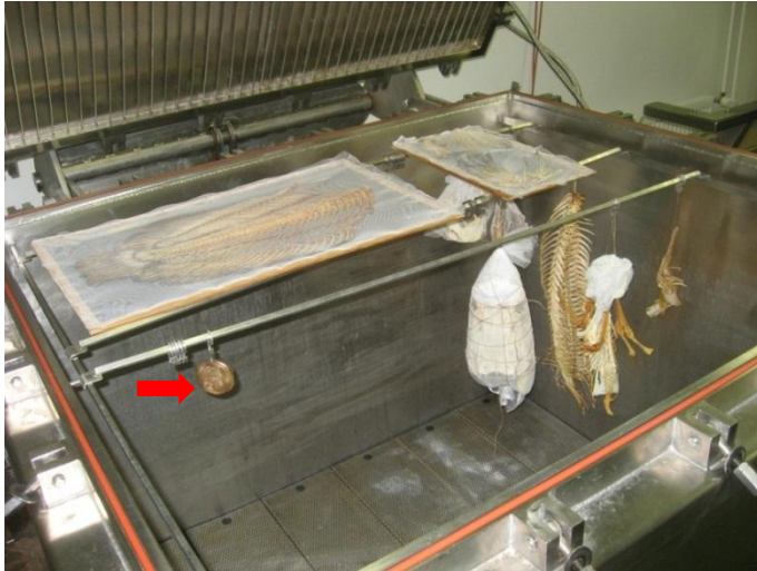
Abb. 65: Knochenentfettungsanlage am Zoologischen Institut der Universität Hamburg mit kontaminierten Proben des Reyer-Epitaphs.
