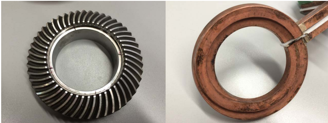
Abbildung 11: Neue Werkstückkontur inkl. zugehörigem Induktor (Neuentwicklung)
