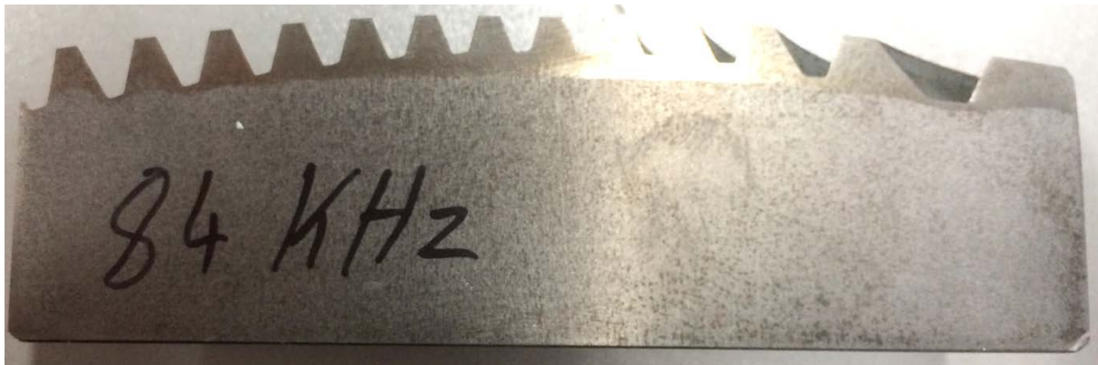
Abbildung 19: Härtebild des mit 84 kHz durchgeführten Versuchs
