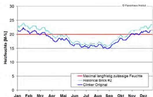
Abb. 36: Jahresverlauf der Holzfeuchte (Berechnung für die 2 Referenzfälle der Steinmodelle; 50% Schlagregenbelastung; 16°C Mindest-Innentemperatur) Quelle: PHI
