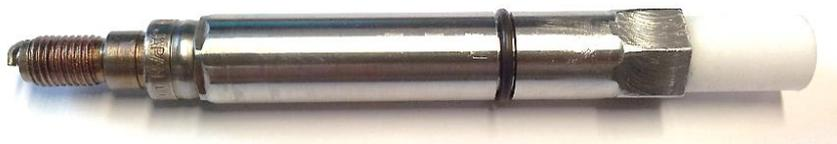
Abbildung 9: M8-Zündkerze für Stationärtemperaturversuche
