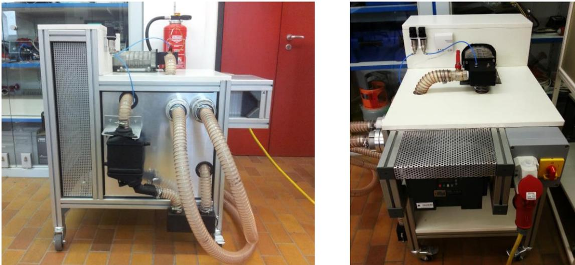
Abbildung 8: Aufladeeinheit mit Roots-Gebläse, Bypass und Ladeluftkühler
