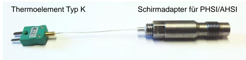
**Abbildung 13: Schirmvariante als PHSI-Ausführung mit Thermoelement zur Messung der Glühstifttemperatur**
