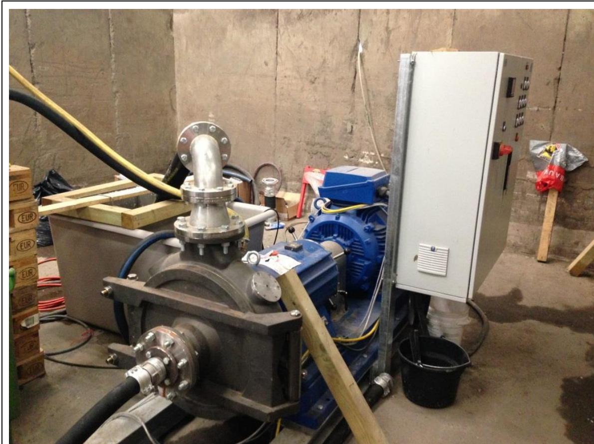
Abb. 2-3: Forschungsanlage: Refiner H2 auf Stahlrahmen mit Schaltschrank
