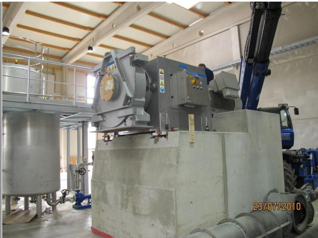
Abb. 5-4: Atmosphärischer Refiner mit Auslass nach unten auf Betonfundament
