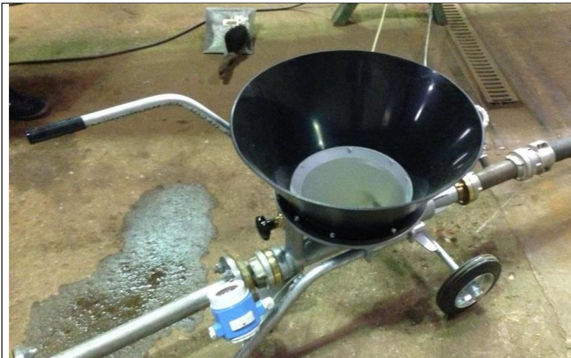
Abb. 3-1: Fahrbare Stahlpumpe mit Aufgabetrichter
