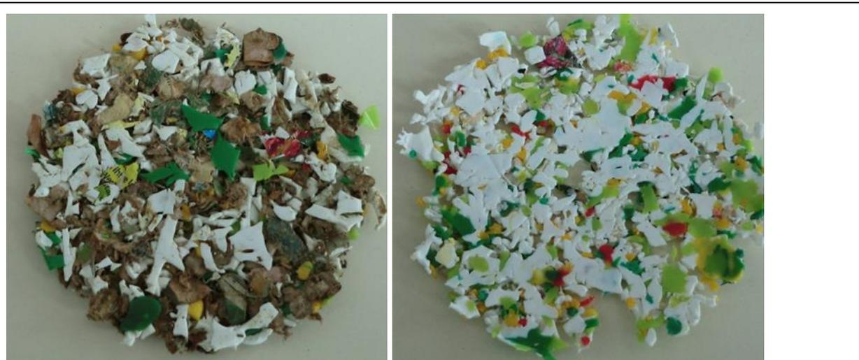
Abb. 4-2: Schmelztest von Probe 2 (HDPE); links: Input; rechts: Output
