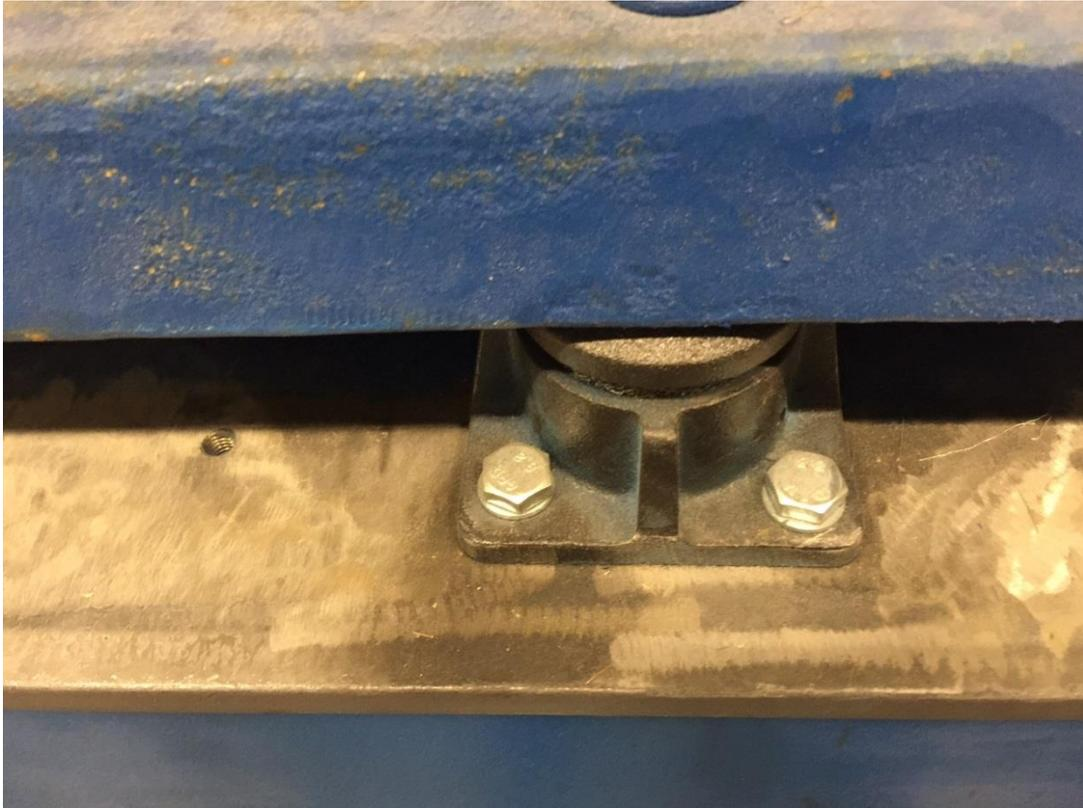
Abb. 7: F2 Vibrationsdämpfer
