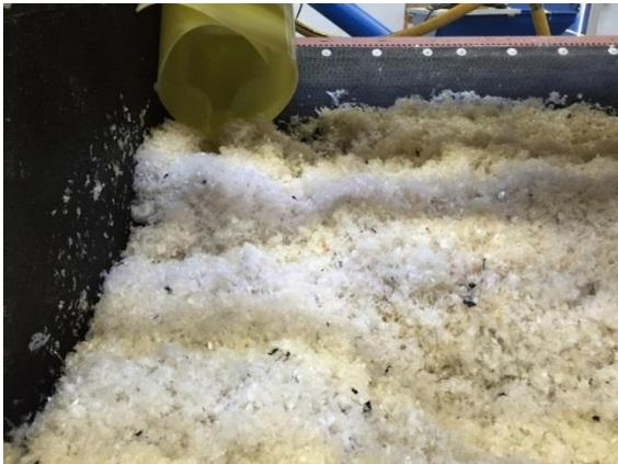
Abb. 13: Output Kunststoff Flakes
