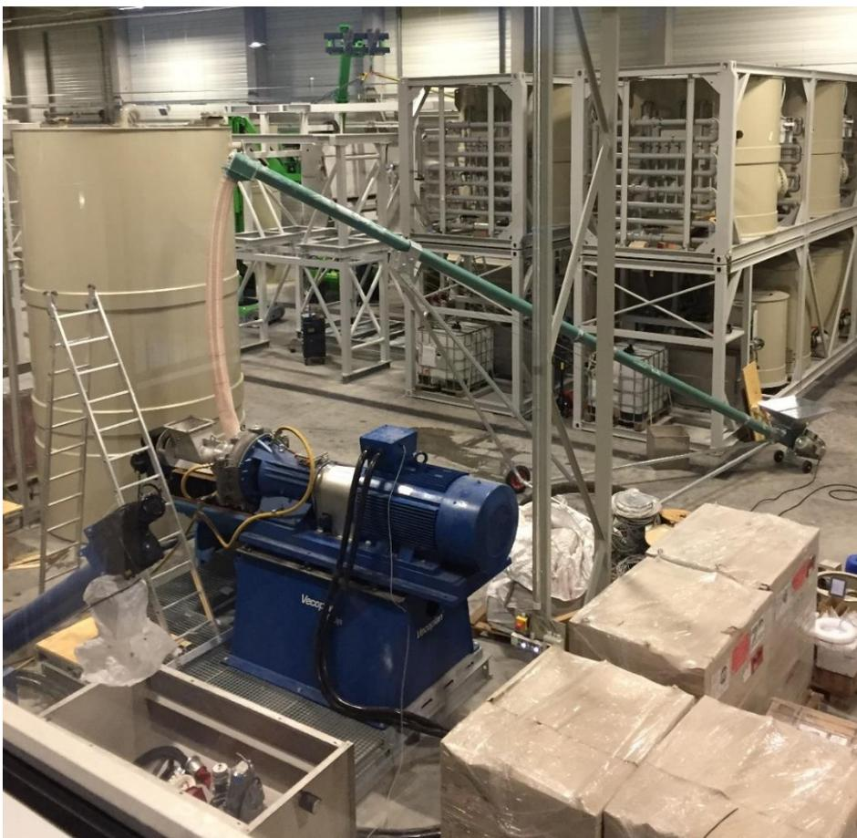
Abb. 8: Prozesswassereintrag mittels manueller Wasserzufuhr
