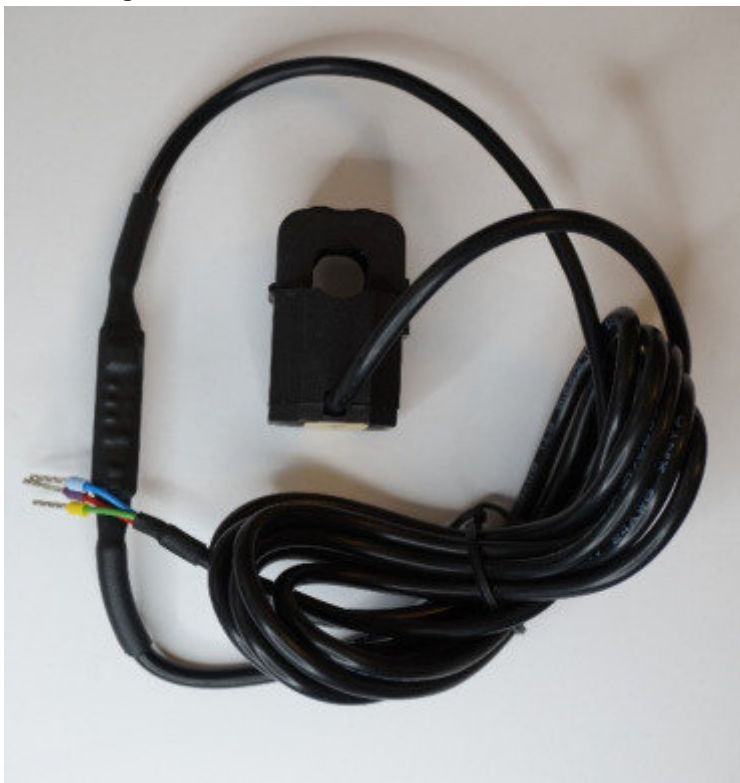
Abbildung 18: Fertig aufgebauter Sensor mit Elektronik zur Signalanpassung
