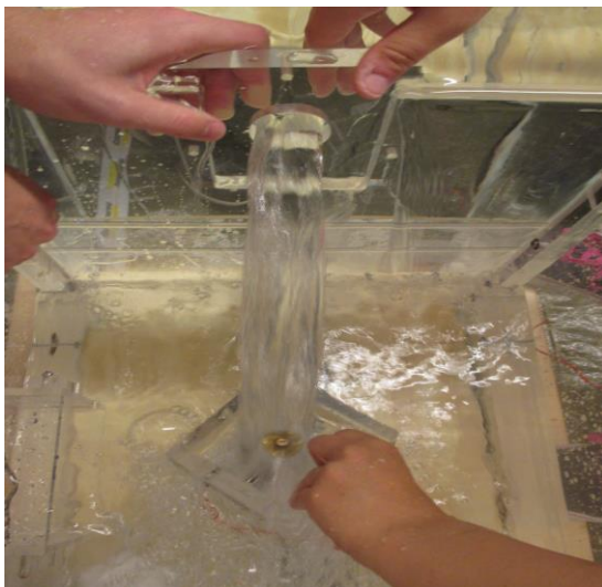
Abbildung 5: Konstruktionen der SuS in den Wasserkraftkursen. Links oben: Turbine im untersten Wehrteil, davor Bauteil mit kleiner Durchlassöffnung. Rechts oben: Bauteil mit Durchlassöffnung im mittleren Wehrteil, der Wasserstrom treibt eine vertikal eingesetzte Turbine im freien Wasser an. Mitte links: Bauteil mit Durchlassöffnung im obersten Wehrteil, Wasserstrom treibt eine Turbine im Schacht an. Mitte rechts: Ähnlicher Aufbau wie Mitte links, der Wasserstrom treibt nun eine horizontal eingesetzte Turbine im Schacht an. Unten links: Bauteil mit Durchlassöffnung im obersten Wehrteil treibt eine horizontal eingesetzte Turbine im freien Wasser an. Fotos: Viktoria von Rheinbabem, Deutsches Museum
