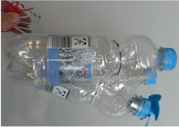
Abbildung 6: Eine als Testmodell mit einfachen Materialien hergestellte Strom-Boje, die beiden oberen Flaschen fungieren als „Schwimmer“, die untere Flasche trägt die Turbine, der Generator befindet sich im Flaschenhals und treibt die LED im Inneren der unteren Flasche an (s. Bild rechts). Fotos: Mike Kramler
