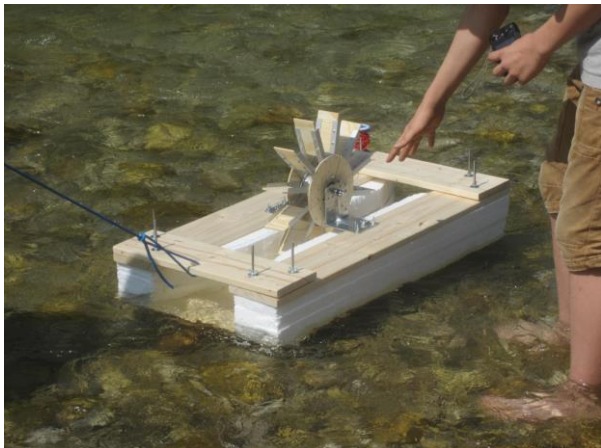
Abbildung 8: Schüler-Praktikanten im TUMlab konzipierten und konstruierten das Wasserkraftschiff (Bild links). Die Styropor-Auflage zwischen den beiden Trägern hält das Wasserkraftschiff über der Wasseroberfläche. Das Schiff kann mittels eines Seils (s. blaues Seil links) in ein Gewässer heruntergelassen und wieder hinaufgezogen werden. Auch das Kabel zum Einspeisen des generierten Stroms in die zu betreibenden Geräte („Verbraucher“) wird am Schiff befestigt und von dort nach oben geführt. Die Messungen und der Anschluss der Geräte können so auf einer Brücke oberhalb des Gewässers stattfinden. Das Modell im Bild rechts ist eine einfacher zu bauende Weiterentwicklung des Wasserkraftschiffs im linken Bild. Die Wasserrad-Bojen erzeugen, bei entsprechender Wasserströmung, genügend Strom, um z.B. ein Radio, einen Ventilator oder ein Funkgerät betreiben. Fotos: Mike Kramler, Miriam Voß
