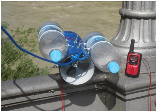
Abbildung 7: Weiterentwicklung des Testmodells – mit dieser Strom-Boje lassen sich bereits ein kleines Radio oder ein Walkie-Talkie betreiben. Foto: Mike Kramler
