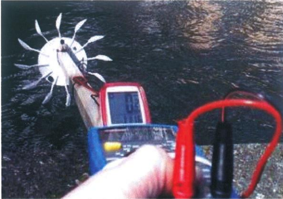
Unsere Fließgeschwindigkeitsmesssonde im Einsatz.
