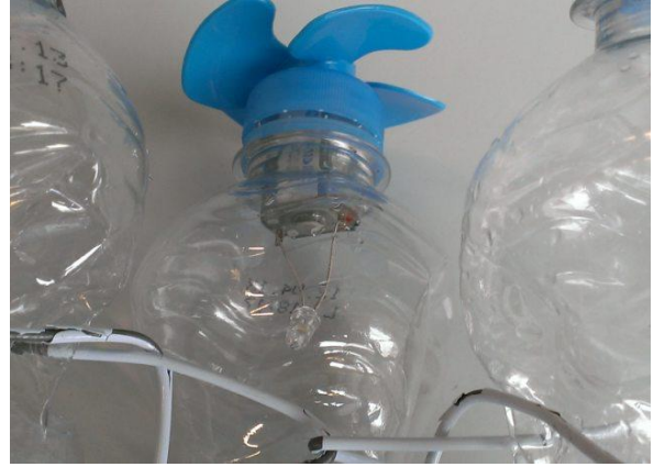
Abbildung 6: Eine als Testmodell mit einfachen Materialien hergestellte Strom-Boje, die beiden oberen Flaschen fungieren als „Schwimmer“, die untere Flasche trägt die Turbine, der Generator befindet sich im Flaschenhals und treibt die LED im Inneren der unteren Flasche an (s. Bild rechts). Fotos: Mike Kramler
