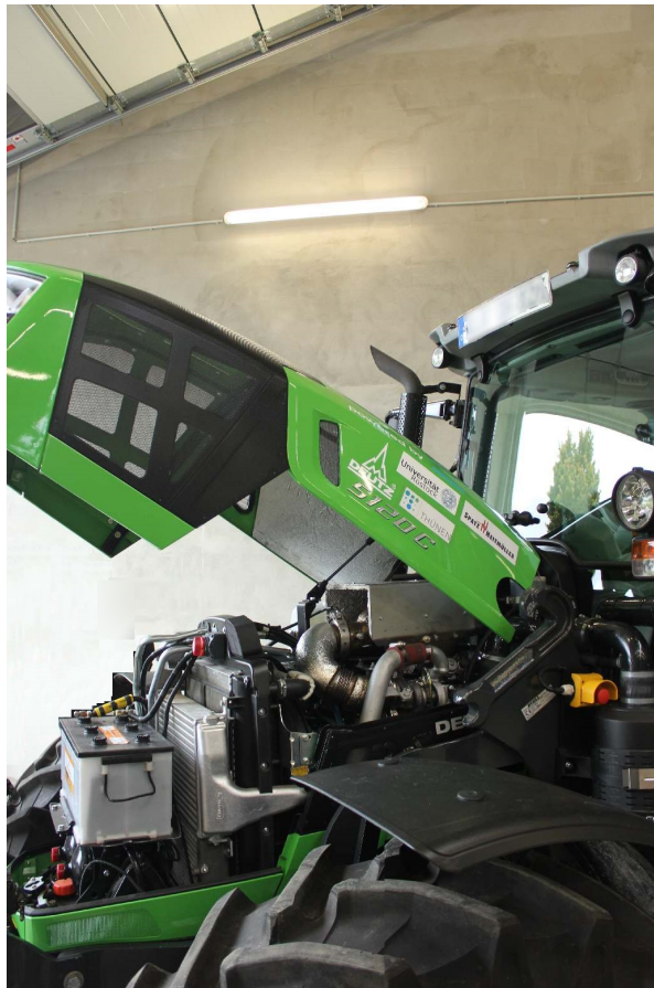
Abbildung 3.19: Integration des Gasmotors und des Abgasnachbehandlungssystems (zwei parallel durchflutete Drei-Wege-Katalysatoren) in den Demonstratortraktor
