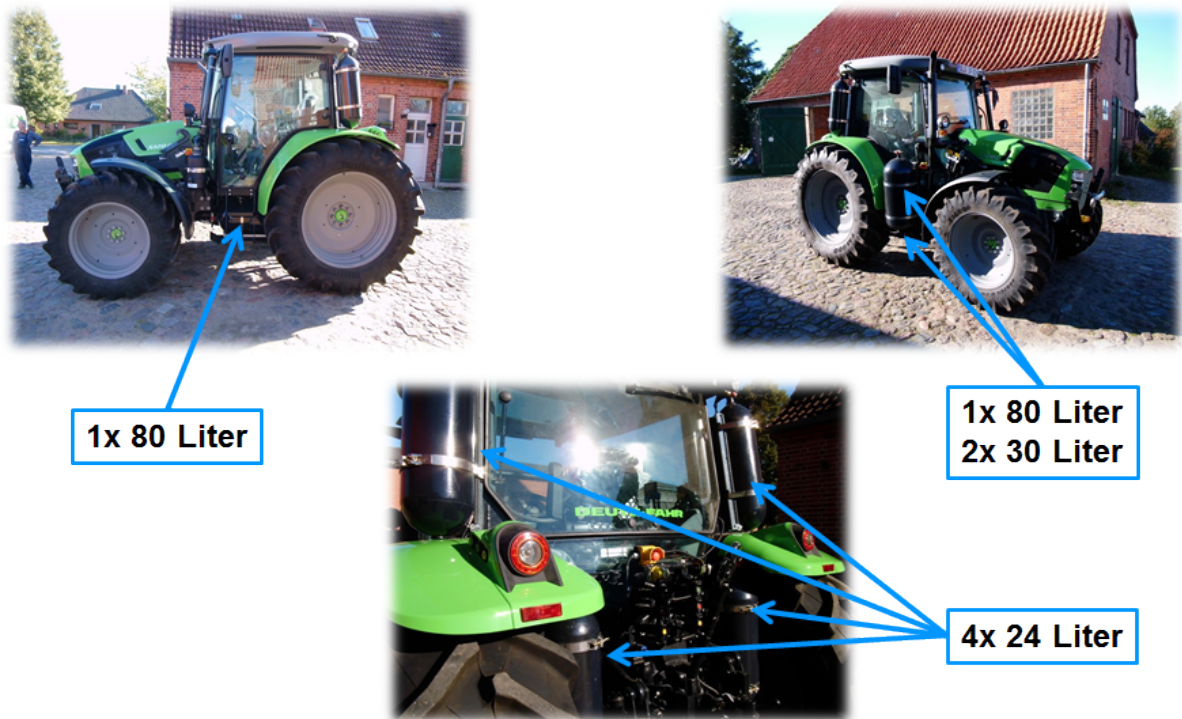
Abbildung 3.20: Unterbringung der acht Gasspeicherflaschen am Versuchsträger (2x 80 l, 2x 30 l, 4x 24 l)
