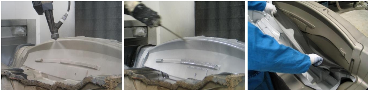
Abbildung 1: Trennmittelapplikation (links) auf einer Form, Kunststoffeintragung (mittig) und Entformung nach der Aushärtung des Kunststoffes (rechts)
