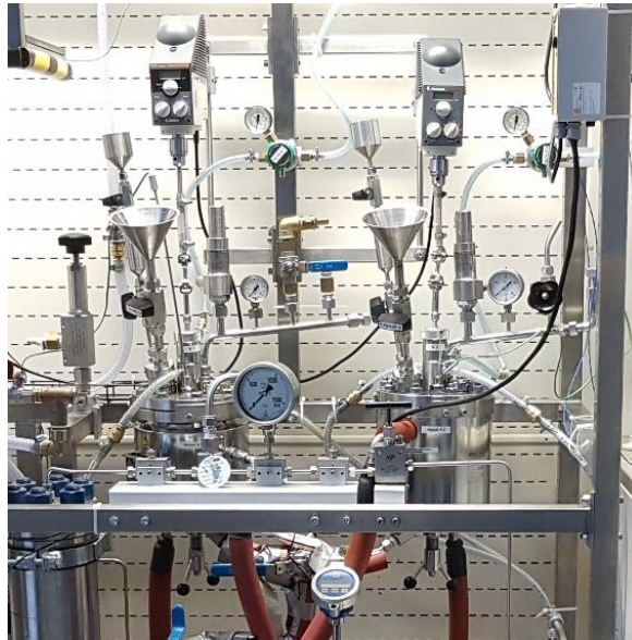
Abbildung 24: Pilotanlage nach Einbau eines zweiten Reaktionskessels
