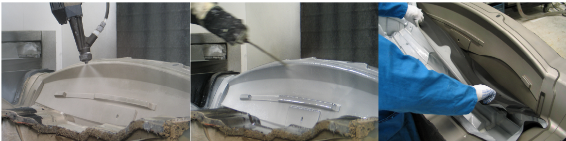
Abbildung 1-3: Trennmittelapplikation (links) auf einer Form, Kunststoffeintragung (mittig) und Entformung nach der Aushärtung des Kunststoffes (rechts)
