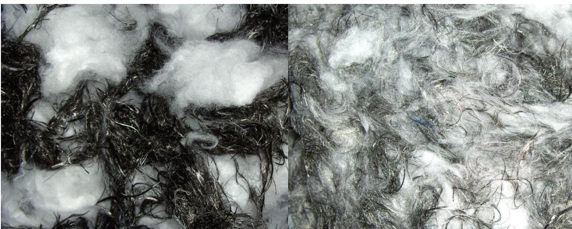
Abb. 6: Voröffnung und Durchmischung von Carbon- und PA-Fasern. Links vor dem Voröffnen, rechts danach.
