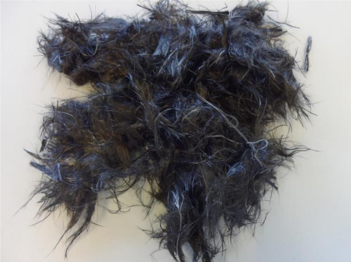
**Abb. 2: Recafil Typ 60, geschnitten und mechanisch aufgerissen**
