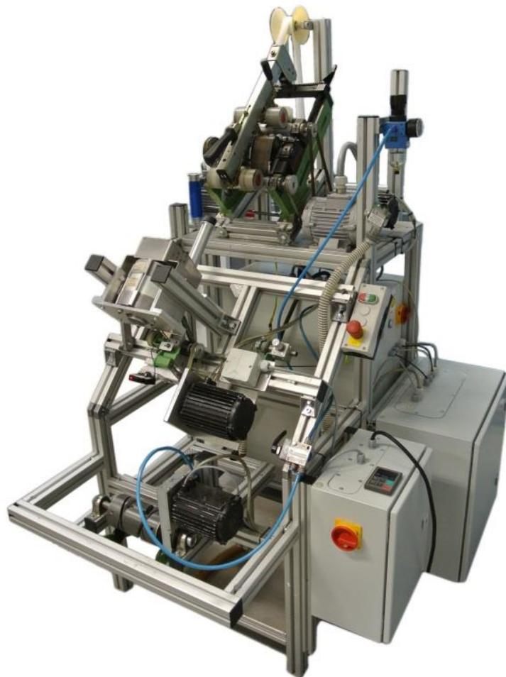
Abb. 12: Umwindespinntester des ITV
