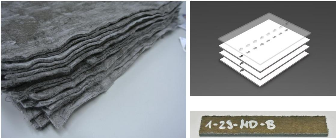
**Abb. 22: Verwendeter Vliesstapel aus Carbon und Polyamid 6 mit Darstellung der Maschinenlaufichtung sowie daraus hergestellter Probekörper**
