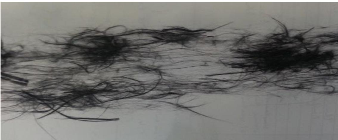
Abb. 13: Entmischtes Faserband nach dem Verzug im Langstapelstreckwerk
