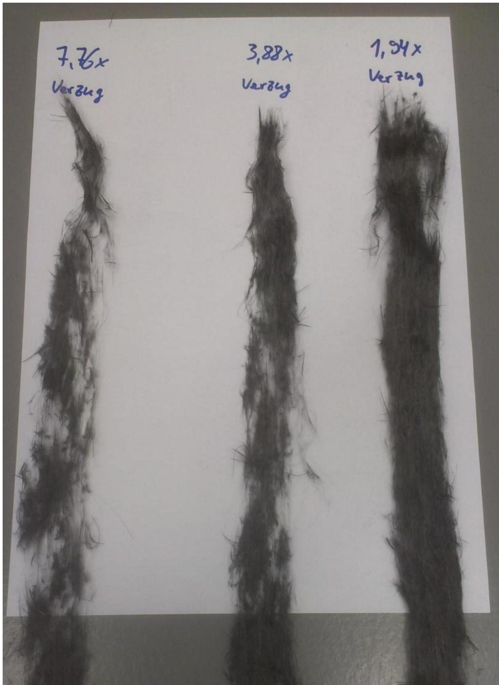
Abb. 14: Faserbänder mit unterschiedlichem Verzug und unterschiedlicher Entmischung
