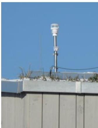
Abbildung 3.3-1: Wetterstation Clima Sensor US auf dem Dach der Aula
