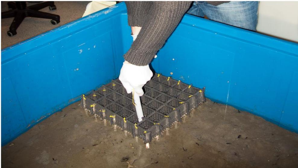
**Abbildung 16** Einbringung der Sedimentbatterie in den Versuchstank
