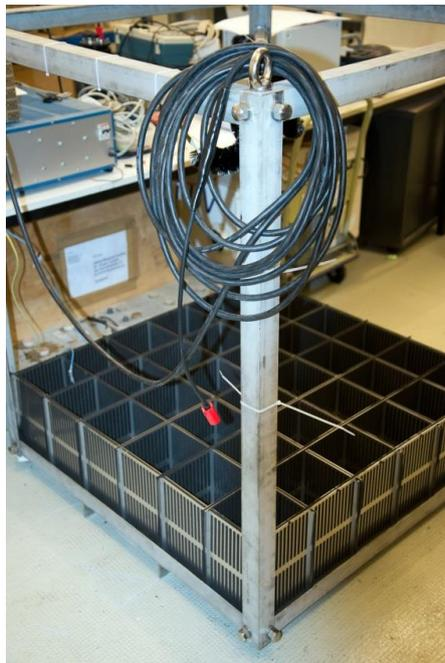
**Abbildung 23** Aufbau des Feldsystems mit gekammerter Edelstahl-Graphitfilz-Anode
