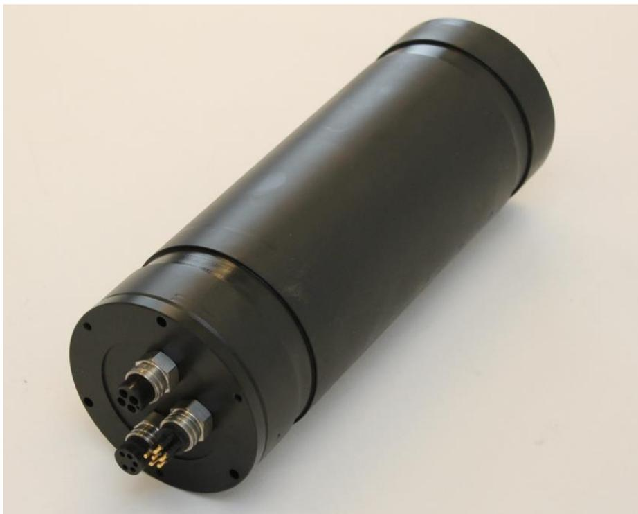
Abbildung 27 Datenlogger-Gehäuse aus Kunststoff (PE-HD) für den Einsatz in Wassertiefen bis zu 300m mit Edelstahl-Unterwassersteckern und innenliegender Elektronik zur Stromversorgung der Sensorsysteme bzw. zur Speicherung des von der BMBZ erzeugten Stroms.
