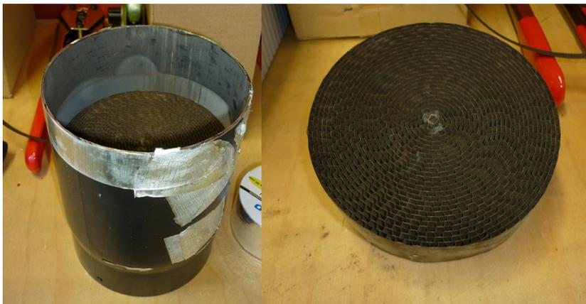
Abbildung 3.19: Verwendeter Wabenkatalysator, links eingebaut in 150 mm Abgasrohr
