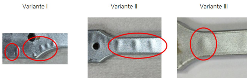
Abbildung 25: Metallisierte Testsubstrate nach dem Klimawechseltest.
