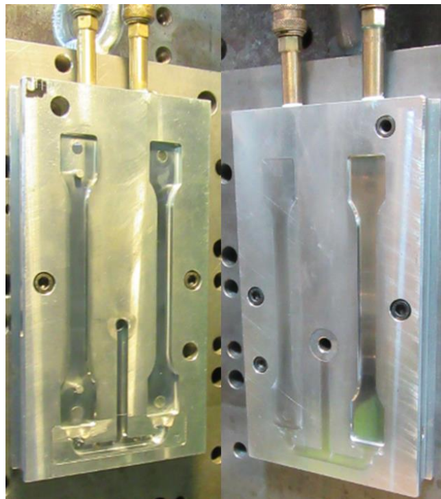
Abbildung 28: Musterwerkzeug für die Entwicklung der in-mould-Beschichtung.
