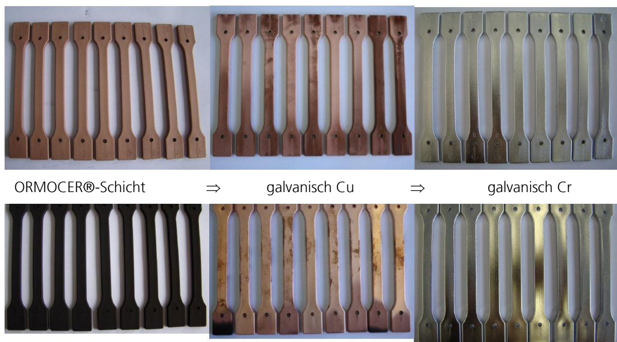
Abbildung 23: Galvanische Cu- und Cr-Abscheidung auf leitfähigen V_Qe ORMOCER®-Schichten. Oben: Kupfer-gefüllte ORMOCER®-Schicht. Unten: RuB-gefüllte ORMOCER®-Schicht
