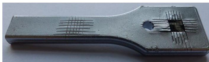
Abbildung 26: Haftungstest an metallisiertem Testsubstrat.
