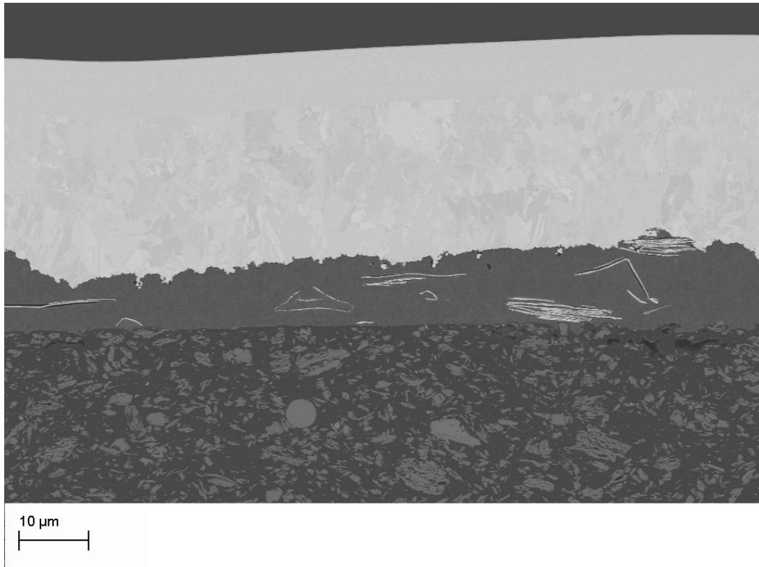
Abbildung 17: REM-Aufnahme des Querschnitts einer metallisierten tauchlackierten Beschichtung.
