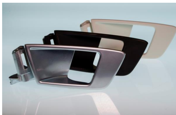
Abbildung 29: Galvanisierter Polyamid-Türhebel (vorne), Polyamid-Rohteil (hinten) und Rohteil mit auflackierter elektrisch leitfähiger ORMOCER®-Beschichtung (Mitte).
