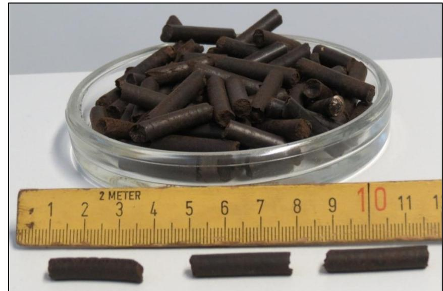
**Abb. 39:** Zu Pellets gepresste carbonisierte Heide, die vorab gemahlen und mit einem Sieb (3 mm Maschenweite) gesiebte wurde
