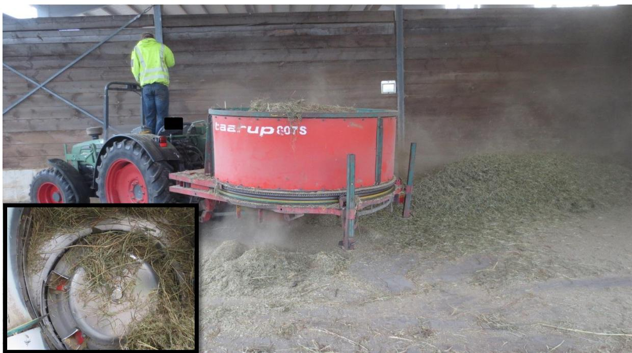
**Abb. 13:** Strohballenhäcksler zur Zerkleinerung der in Rundballenform angelieferten Landschaftspflegemischung auf etwa 4 cm sowie Darstellung des Schneidwerkzeugs (kleines Bild links)
