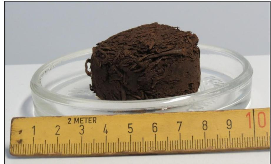
**Abb. 38:** Unbehandelte carbonisierte Heide (roh, wf) zum Brikett verpresst
