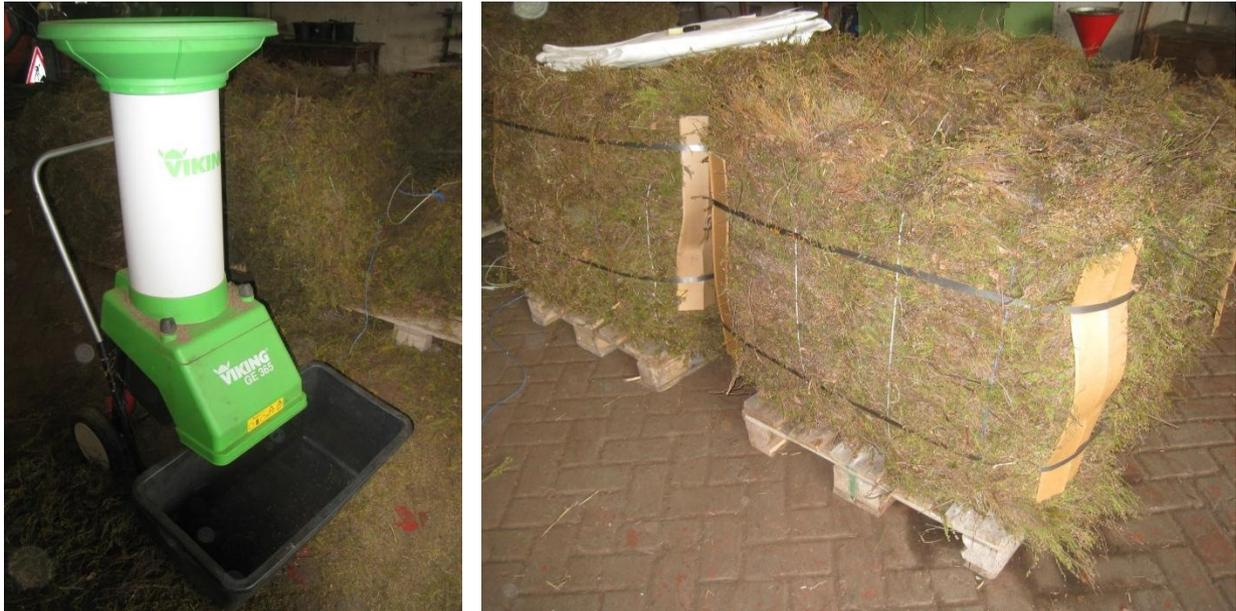
**Abb. 14:** Gartenhäcksler der Firma Viking zur Zerkleinerung der Heide (links) sowie Darstellung der in Quadern angelieferten Heide (rechts)
