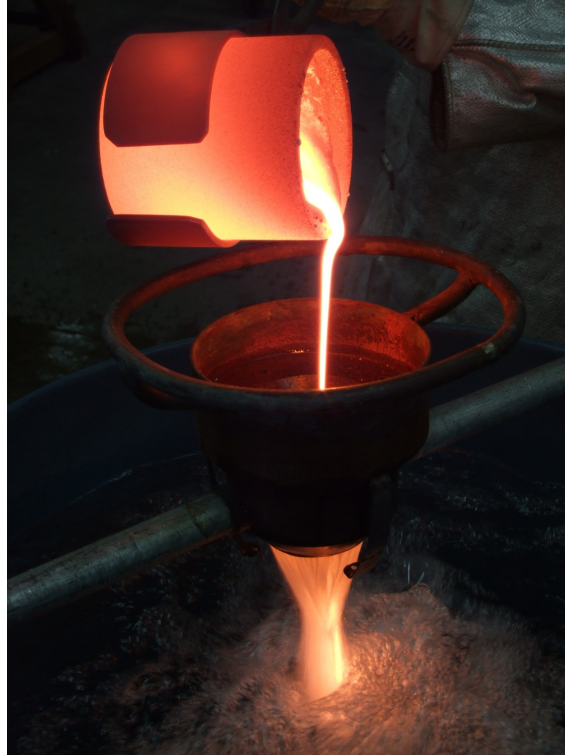
Bild 39: Erzeugung von Hüttensand im Schmelzlabor des FEhS-Instituts
