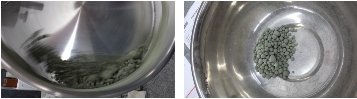
Bild 12: Probenpräparation zur Konditionierung der reduzierten EOS bei Trennung der Verfahrensschritte Reduktion und Konditionierung durch Pelletierung (EOS-Klinker KS8)
