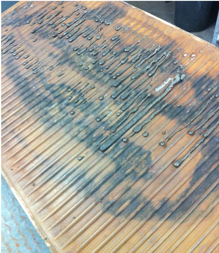
Bild 10: Erstarter EOS-Klinker KS5 auf der Abkühlrampe (vgl. Bild 9, links)
