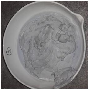
Schlamm aus gemahlener reduzierter EOS, Kalkhydrat, Sand und reinem Fe 2 O 3
