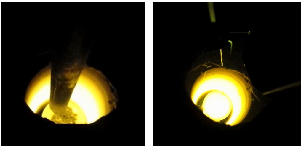
Bild 11: Reduktionsversuch mit Zugabe von 9 M.-% Sekundäraluminium (EOS-Klinker KS100)
