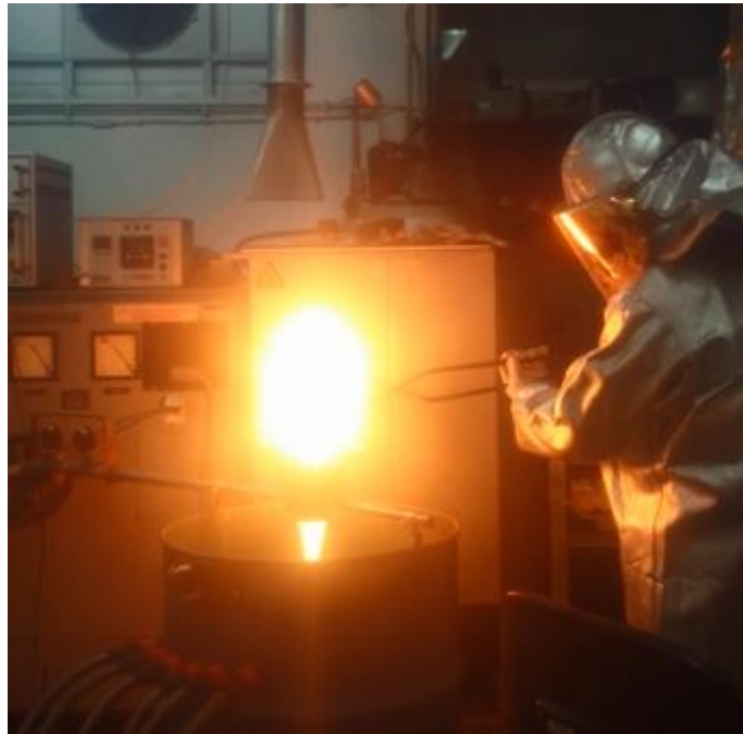
Bild 40: Erzeugung von EOS-Hüttensand KS10
