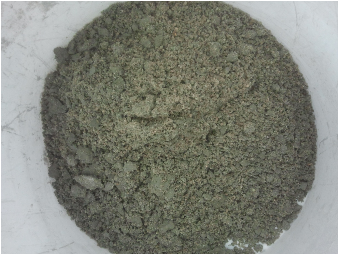
Bild 55: Frishmörtel mit einem Zement aus je 50% EOS-Klinker KS6 und Industrieklinker L ( w/z = 0,5 )
