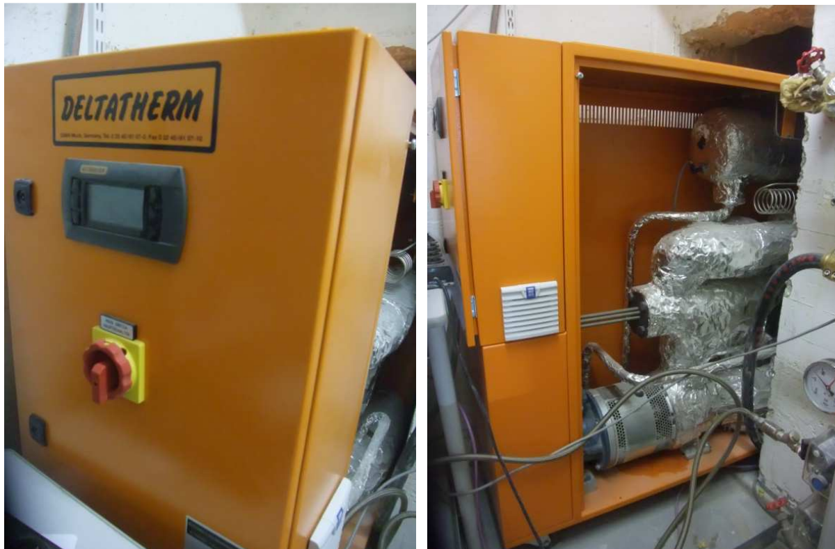
Bild 2: Temperiergerät TMO300 der Firma Deltatherm
