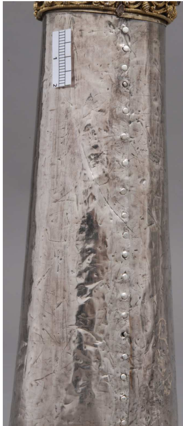
Abbildung 40+41 Detail Armrückseite, fixierte Naht mit ergänzten Nägeln
