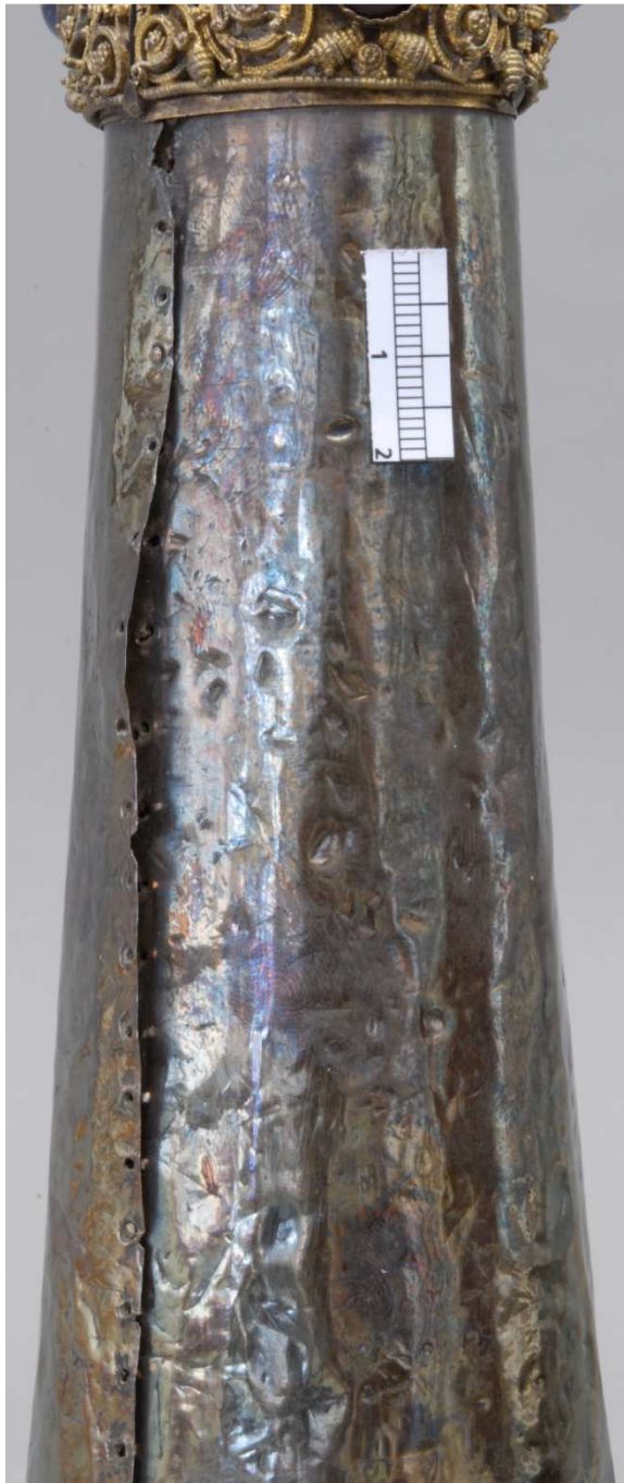
Abbildung 14+15 Detail Armrückseite, geöffnete, deformierte Naht
