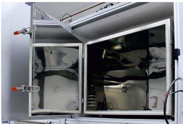
Abbildung II-30 und II-31. Schema (oben) und Foto (unten) einer Emissionsprüfkammer.
