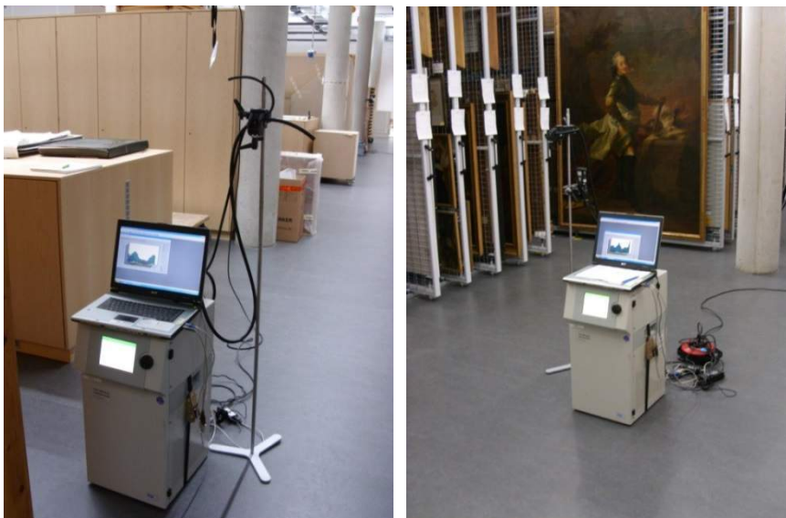
Abbildungen II-34 und II-35. Raumluft- und Partikelmessungen im Depot des Kupferstichkabinetts (links) und der Gemäldegalerie (rechts).
