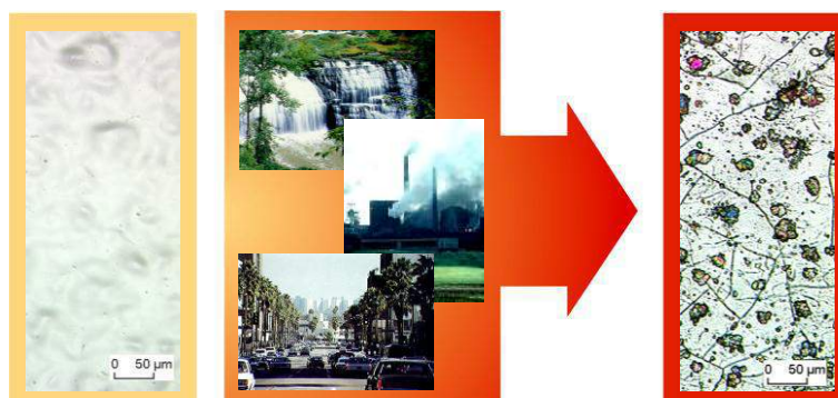
Abbildung 1: Mikroskopische Darstellung einer Glassensor-Oberfläche vor und nach korrosivem Angriff durch unterschiedliche Umwelteinflüsse.
