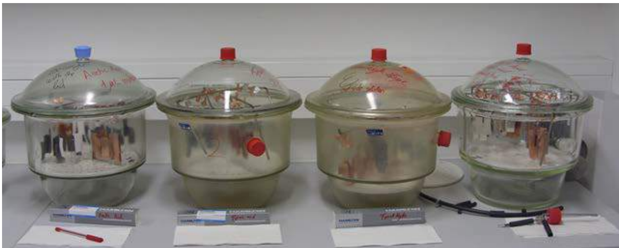
Abbildung II-6: Versuchsaufbau. In Exsikkatoren über einer Dotierlösung befestigte Metallcoupons.
