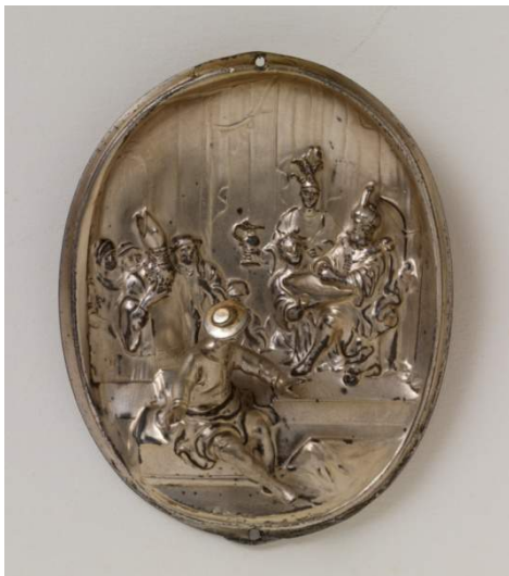
Abbildungen II-3a und II-3b: Medaillon aus Feinmetall, Applikation eines Elfenbeinkreuzes, um 1703. Schwarze Korrosionsschichten auf Vorder- (a) und Rückseite (b), insbesondere auf den Höhen der reliefartig gearbeiteten Darstellung (Fotos: Ursel Gaßner).
