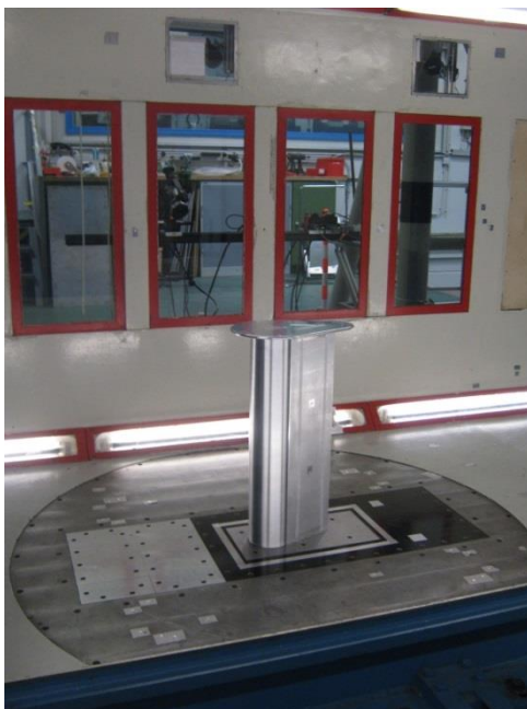
Abbildung 16: Rotormodell 2, Rotorprofil kleines Streckungsverhältnis (1:5)
