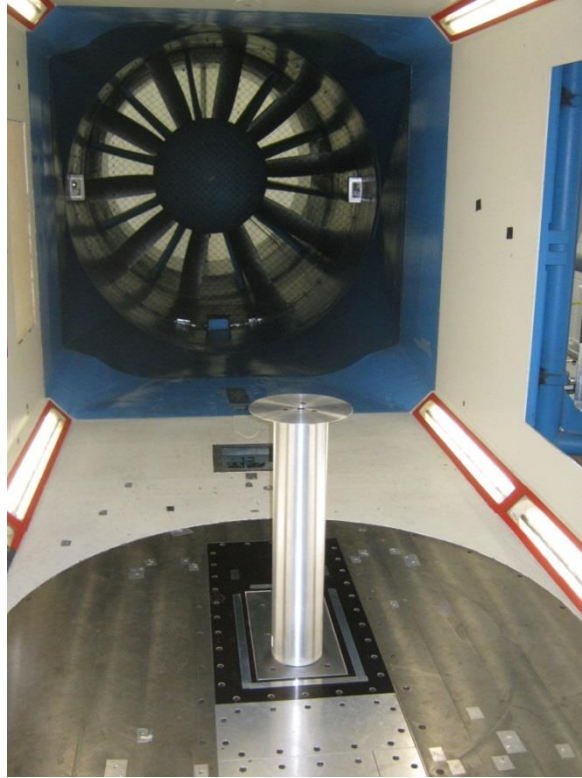
Abbildung 15: Rotormodell 1 (Flettner-Rotor zur Kalibrierung)
