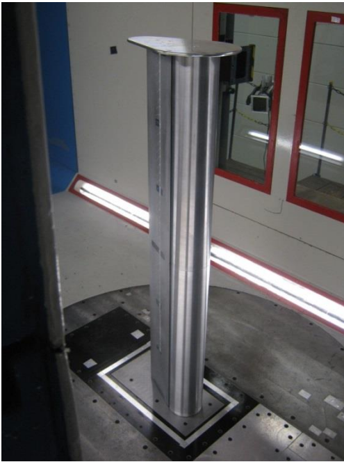
Abbildung 19: Rotormodell 3, Rotorprofil großes Streckungsverhältnis (1:10)
