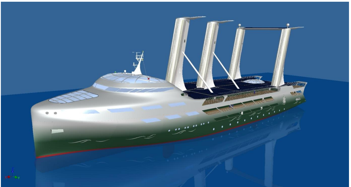
Abbildung 29: Anwendungsbeispiel 4 (Extremer Monohull-Entwurf mit speziell für den Segelbetrieb optimiertem Unterwasserschiff (INNOVEN))
