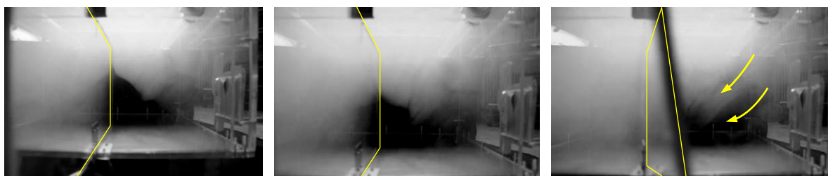
Abbildung 16: Lee-Strömung (Paddleffekt) und erzeugter Überdruck an schwenkendem Drehtisch 2
