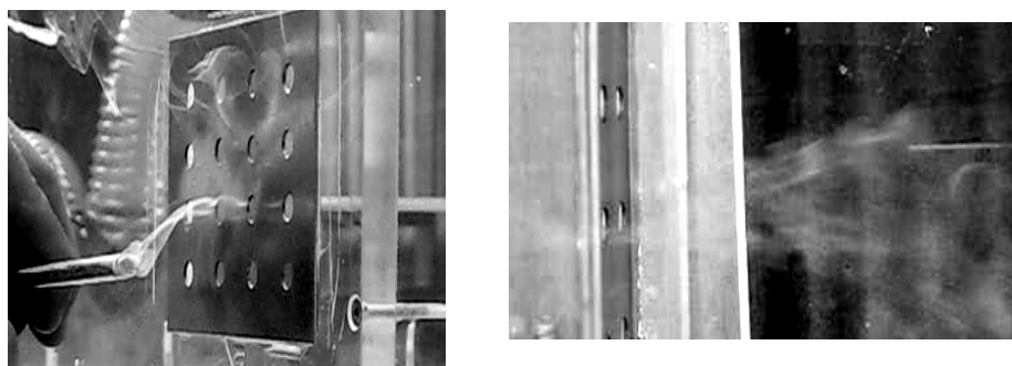
Abbildung 14: Strömungsverlauf der Umgebungsluft in die Kabine
