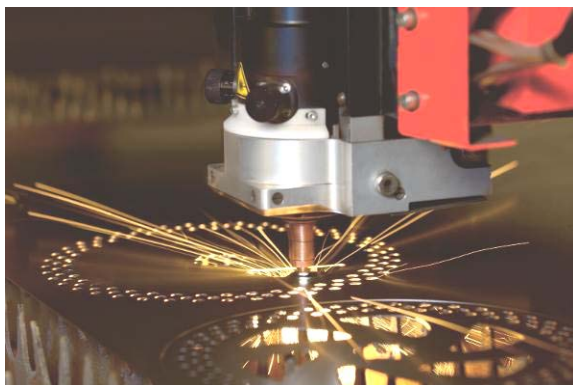
Schneidlaser bei der Arbeit
