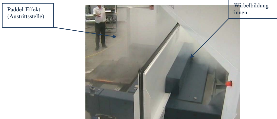
Abbildung 10: Paddel-Effekt und Wirbelbildung an Drehportal
