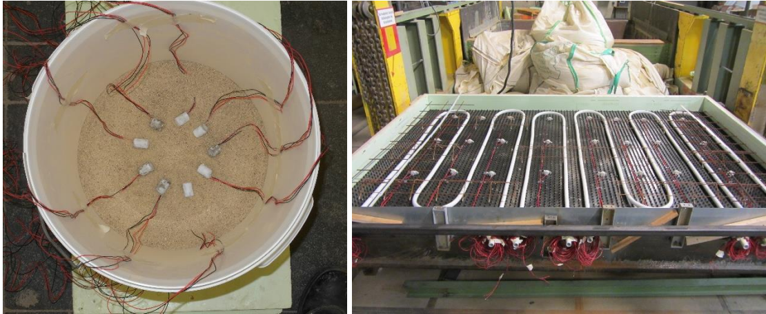
Abbildung 3-3: Präparierung der Temperatursensoren PT100 (links) und Einbau (rechts)
