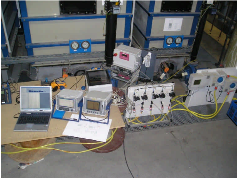
Abbildung 11: Messaufbau im Nettebad für die Onlinemessung von Trübung und Partikelanzahlkonzentration
