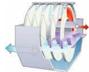
Abbildung 1: Beispiele für anlagentechnische Varianten der Siebfiltration in Form von Trommel- und Scheibenfiltern
