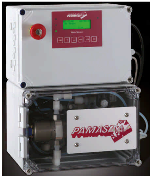
Abbildung 10: Im Netzebad eingesetztes Partikelzählgerät (WaterViewer, Fa. PAMAS, Rutesheim)
