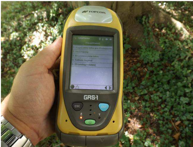
Abb. 54+55): Bestandsaufnahme mit dem GRS-1 Handempfänger der Firma Topcon. (Fotos: P. Pauli)
