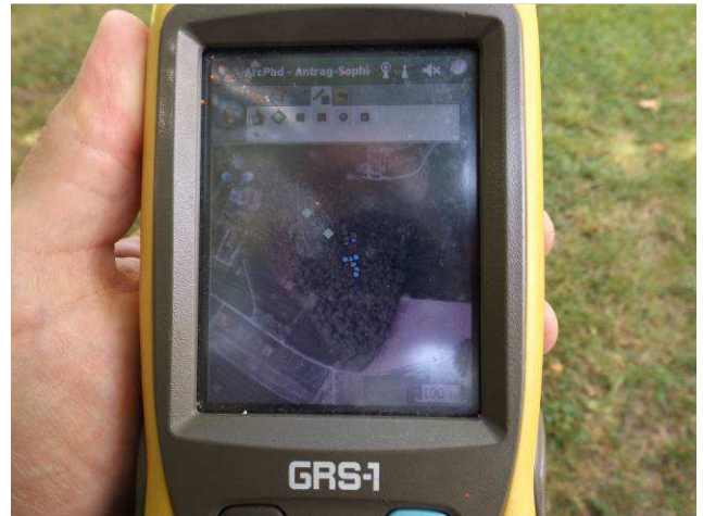
Abb. 54+55): Bestandsaufnahme mit dem GRS-1 Handempfänger der Firma Topcon. (Fotos: P. Pauli)
