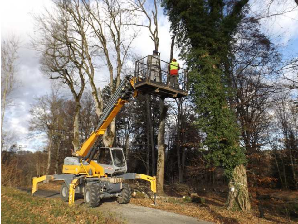
Abb. 269: Baumfällarbeiten mit einer Hubarbeitsbühne. Durch die Straße und die gute Zugänglichkeit zum Bestand sind die Voraussetzungen für einen effektiven Einsatz der Hubarbeitsbühne erfüllt. (Foto: M. Jauch)
