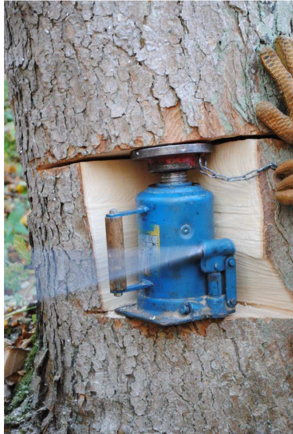
Abb. 268: Wagenheber als hydraulische Fällhilfe. (Foto: M. Jauch)
