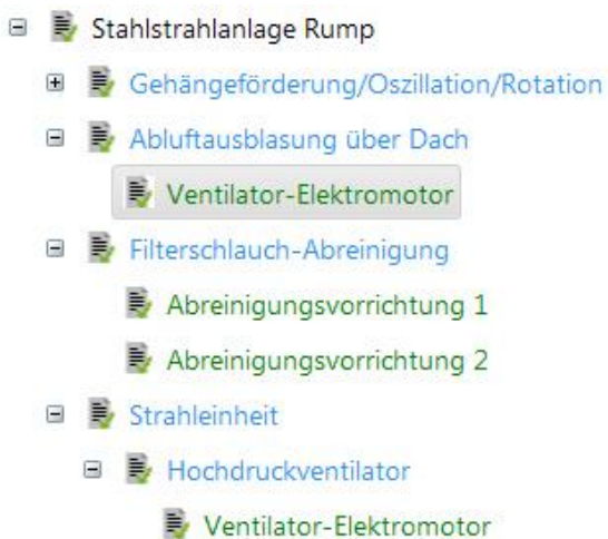
Abb. 10 Baumartige Abbildung des Prozessschemas
