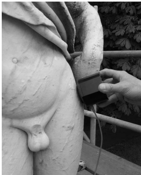
Anbringung des Messkopfes auf der Oberfläche der Marmorskulptur
