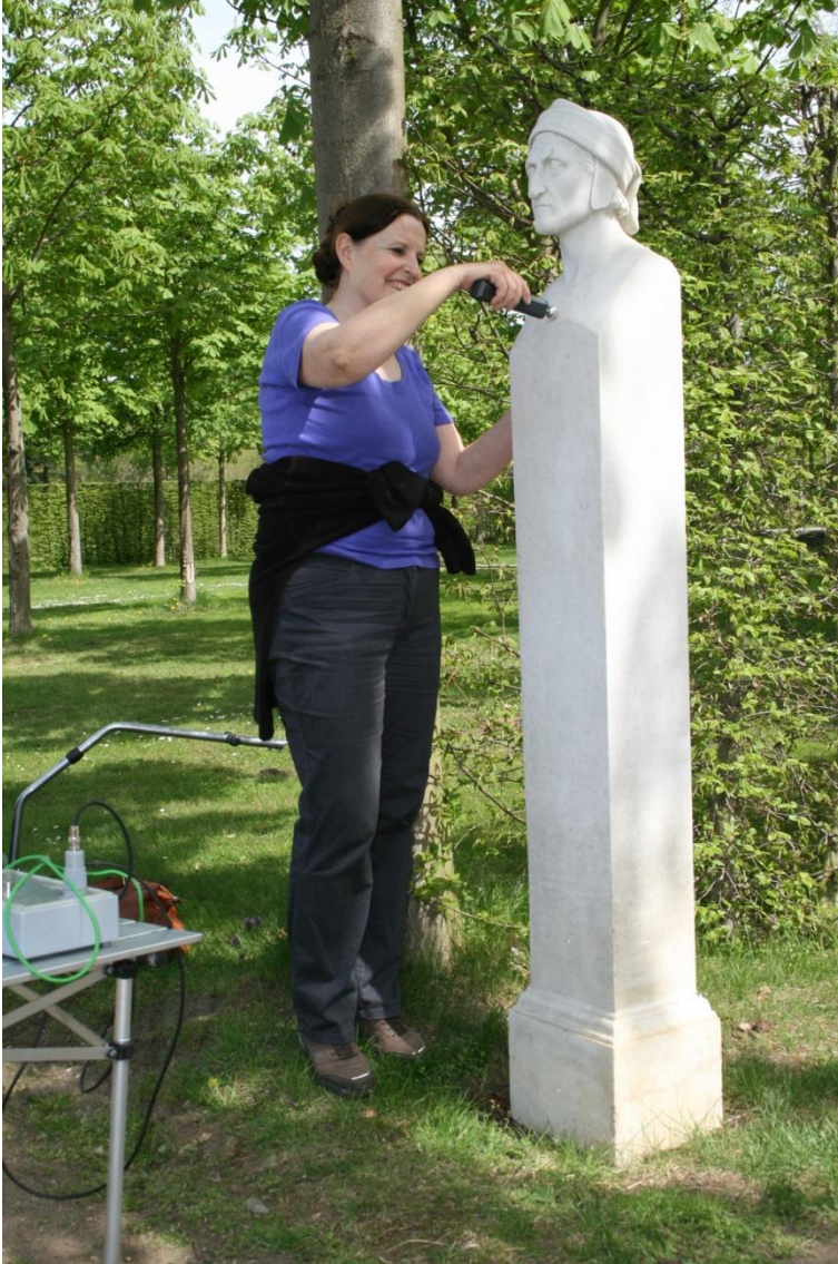
Feuchtigkeitsmessungen mit der Gann-Hydromette an der Stele des „Dante“ (Foto: W.Köhler)
