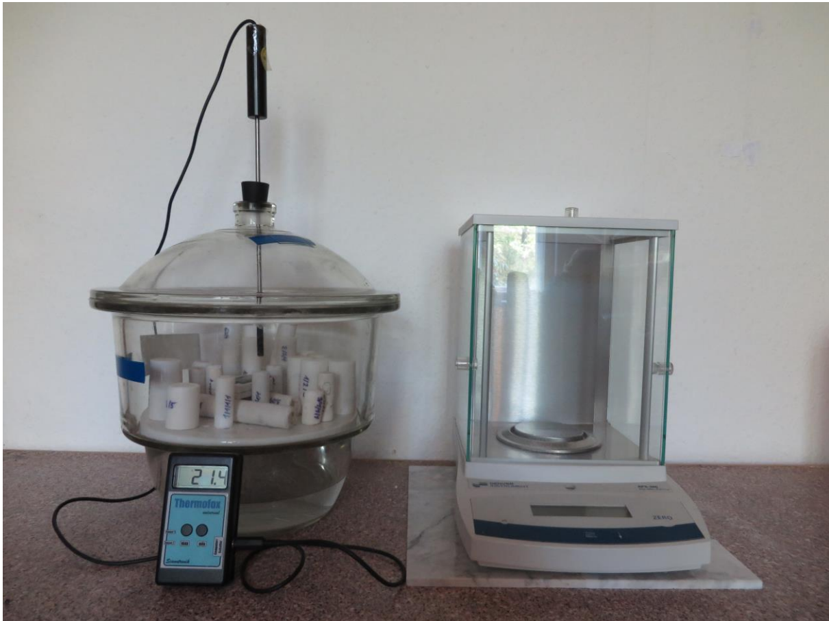
Messanordnung für Sorptionsmessungen
