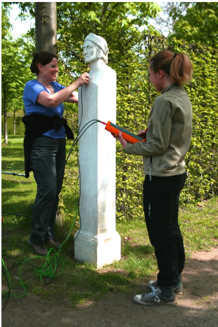
Ultraschallmessungen an der Stele des „Dante“ (Foto: W.Köhler)
