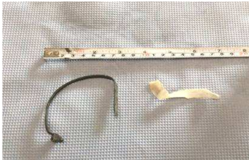
Abb. 5: Kabelbinder und Kunststoffteilchen wurden in der Pumpe vor dem Schneidwerk gefunden.
