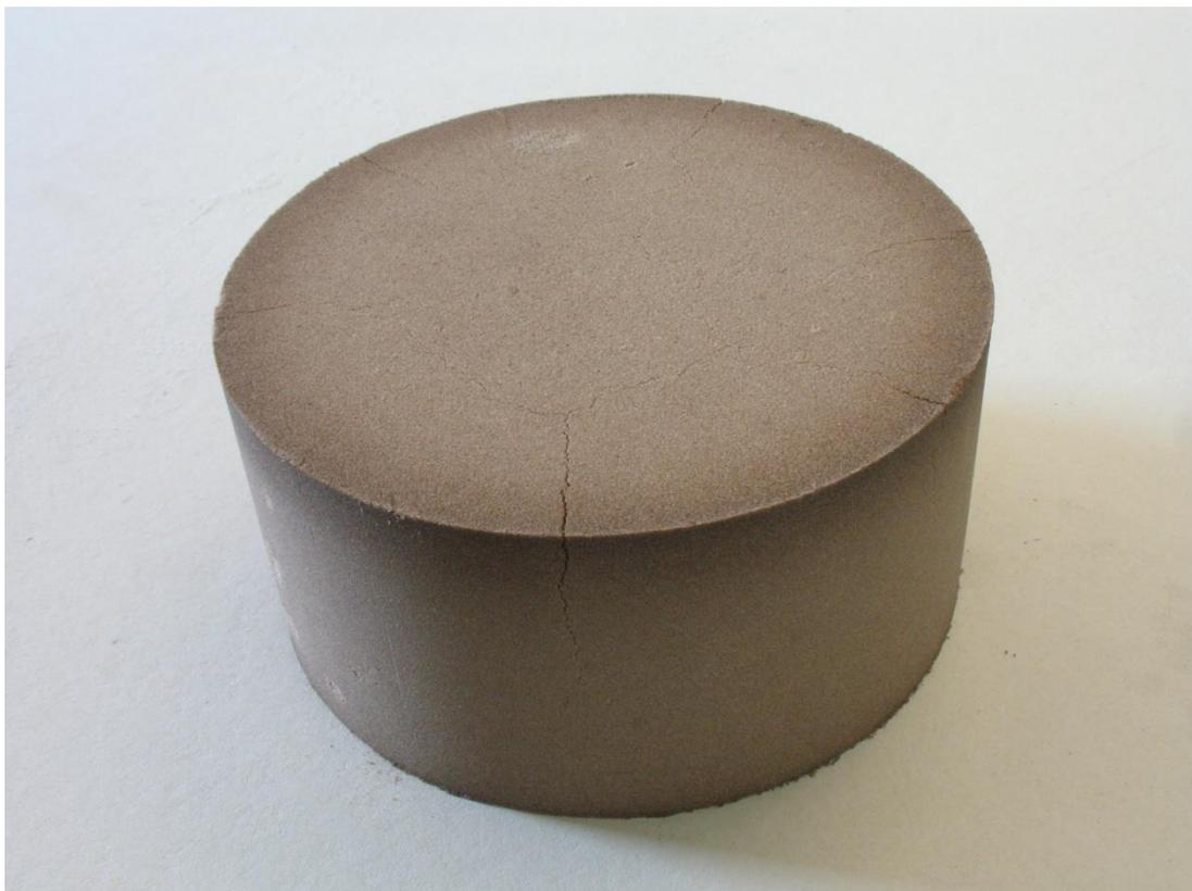
Abb. 8 Probekörper  $\varnothing$  203 x 100 mm mit 40 Masseprozent Oxalsäure nach dem Entbindern (130°C / Haltezeit 24h)
