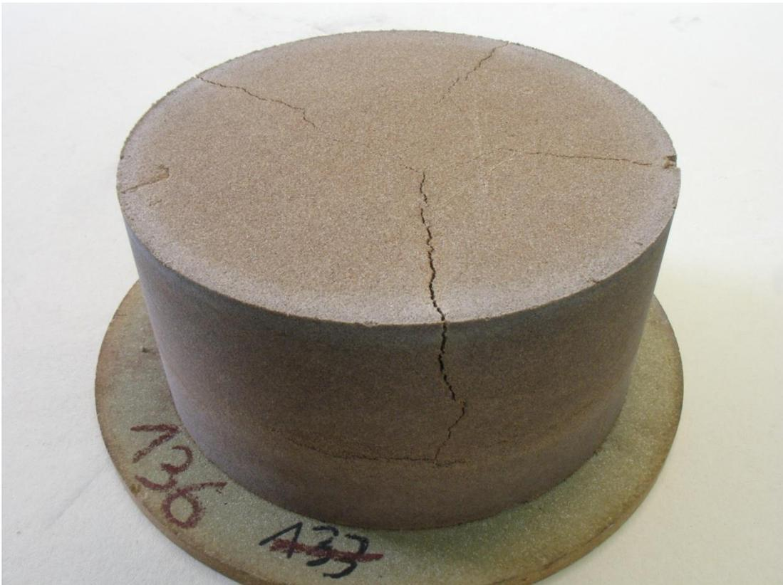
Abb. 26 Probekörper  $\varnothing$  203 x 100 mm mit 20 Masseprozent Oxalsäure (T1661.8) nach dem Entbindern
