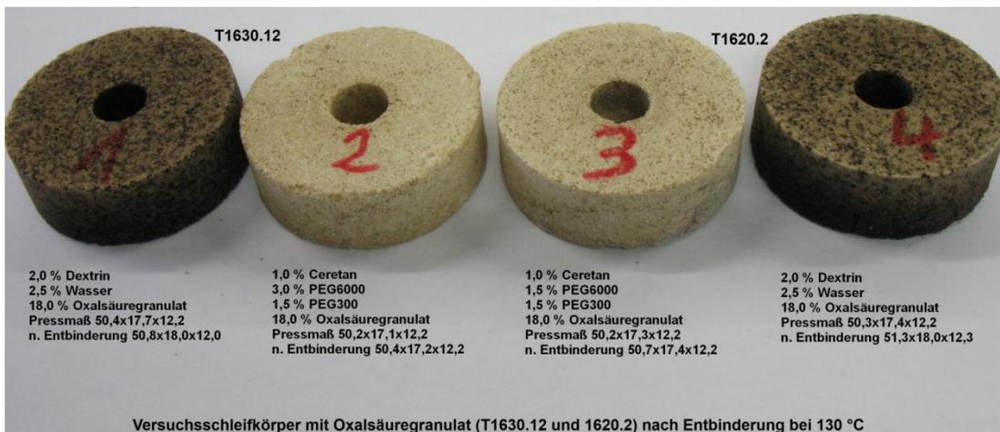
Abb. 23 Kleinschleifkörper mit Oxalsäuregranulat T1620.2 und T1630.12 nach dem Entbindern 1 und 4 und nach dem Brennen 2 und 3
