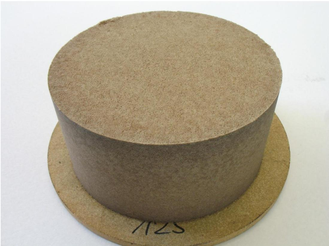
Abb. 25 Probekörper  $\varnothing$  203 x 100 mm mit 20 Masseprozent Oxalsäure (Charge T1658) nach dem Entbindern
