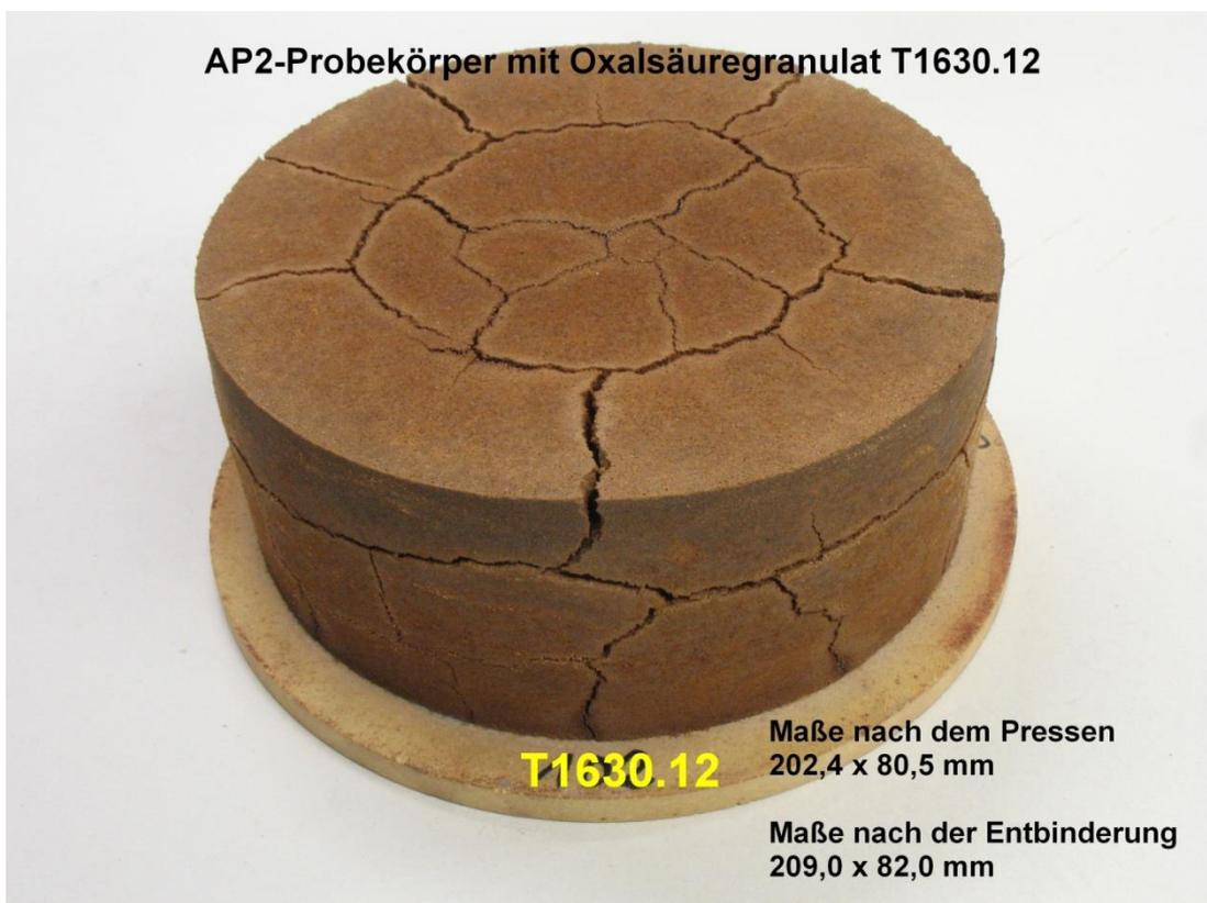
Abb. 24 Probekörper  $\varnothing$  203 x 100 mm mit 20 Masseprozent Oxalsäure
