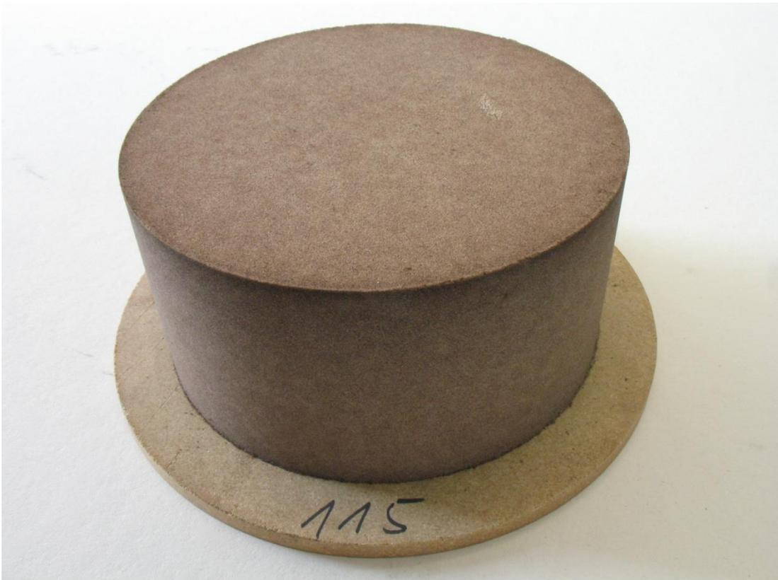
Abb. 10 Probekörper  $\varnothing$  203 x 100 mm mit 40 Masseprozent Oxalsäure nach dem Entbindern (120°C / Haltezeit 24h)
