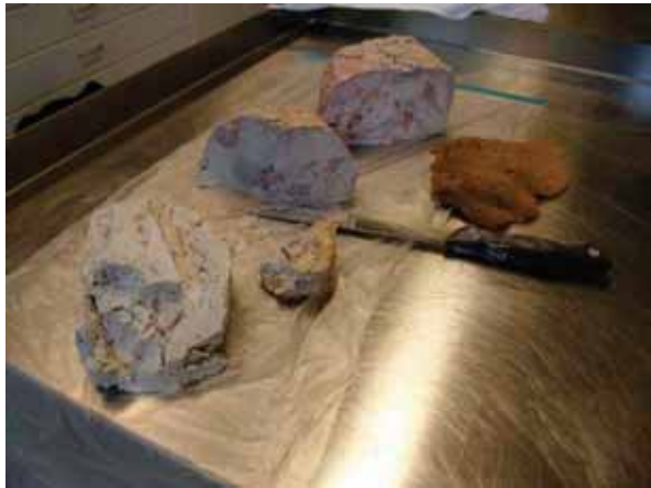
Abb. 84 Verarbeitungsfertige marmorierte „Gipsbrote“ mit unterschiedlicher Pigmentierung und Struktur
