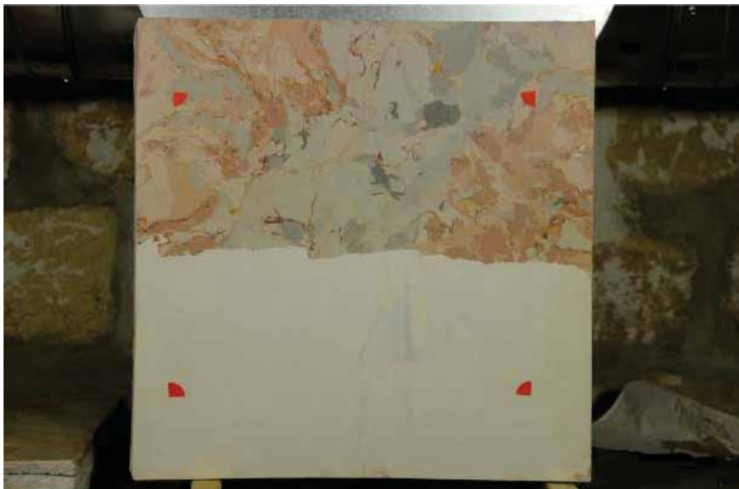
Abb. 86 Gipsstucktestplatte (Aufnahme nach Versuchsdurchführung)
