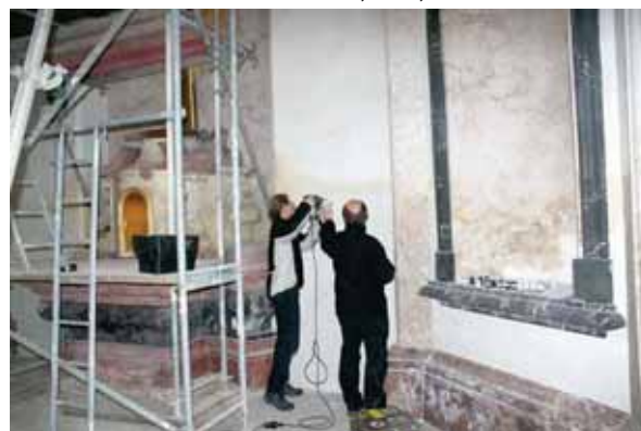
Abb. 43 Probenahme von Bohrmehlproben an der Musterfläche
