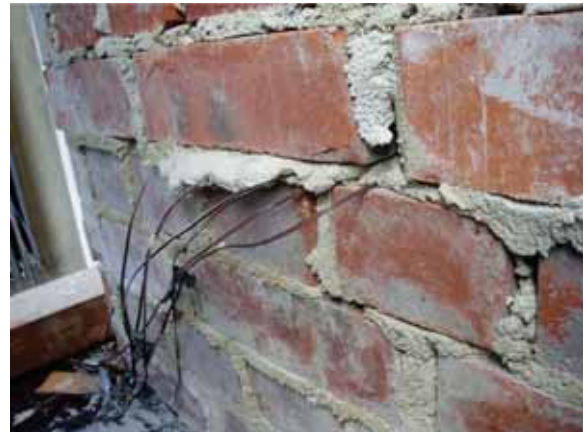
Abb. 79 Rückseite des Probekörpers mit Kabeln der Temperaturmesssonden
