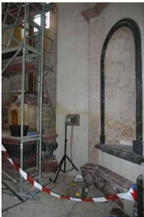
Abb. 20 Musterfläche, MW-Behandlung mit in 3 Höhenstufen, Aufnahme am 05.05.2011
