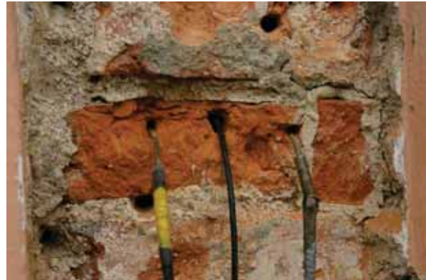
Abb. 120 Anordnung der Temperatursensoren
