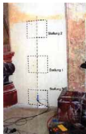
Abb. 39 Musterfläche, MW-Behandlung mit in 3 Höhenstufen, Quelle: bhd-Bericht
