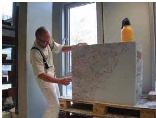
Abb. 82 Herstellung der Gipsstuckoberfläche durch Herrn Glauche
