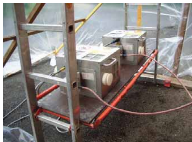
Abbildungen 03 und 04: Antennen in der Endstellung des Versuches, im Sockelbereich so- wie witterungsgeschützt aufge- stellte Magnetrone. Der Steuer- stand war im Fahrzeug eingerichtet worden (siehe Abb.01/ 02)
