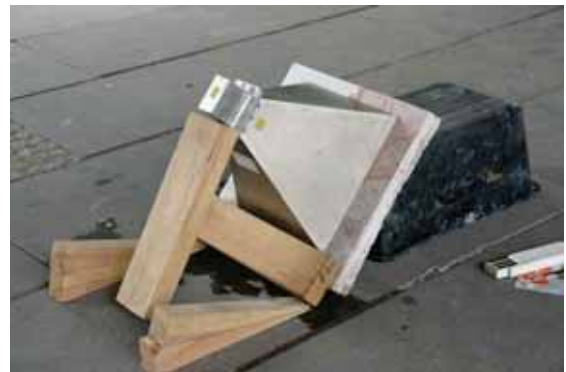
Abb. 91 Anlegen der Antenne
