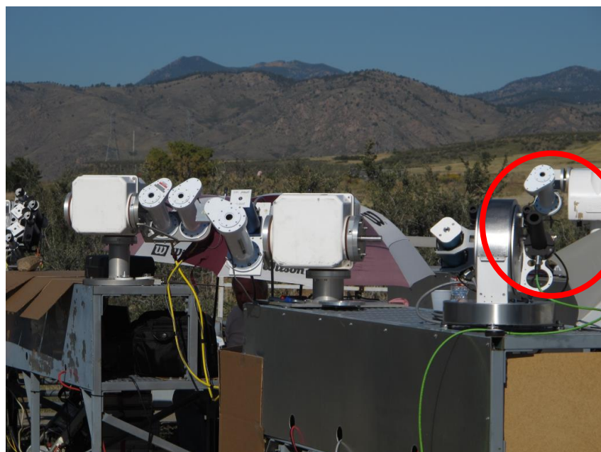
Abbildung 35: Der Sensor SE-185 während der “National Pyrheliometer Intercomparison” in Golden, Colorado, USA.
