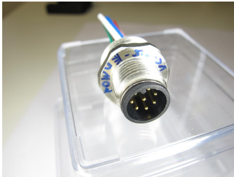
Abbildung 29: Flanschstecker VC-015-EnMO2 während der Temperaturwechseltests
