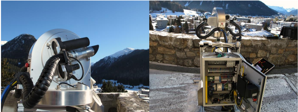
Abbildung 16: Links: die neu entwickelte Nachführeinheit, hier bestückt mit einem Top-Komponentenzell-Spektralsensor, einem Pyrheliometer zur thermischen DNI Messung, sowie einem Tracking Sensor zur hochgenauen Positionierung. Rechts: Nachführeinheit mit Systemelektronik. Die integrierte Wettersensorik ermöglicht die Erfassung aller relevanten Parameter wie Wind, Temperatur und Luftfeuchte.
