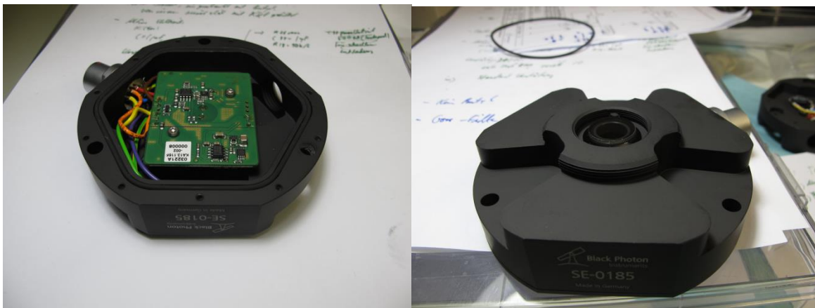
Abbildung 17: Der Sensor SE-185 während der Produktion. Links: Die Unterseite des Sensors ist geöffnet, sodass die Verstärkerelektronik sowie die zum neuen Stecker führenden Leitungen zu sehen sind. Rechts: Ansicht von oben mit Eintrittsfenster und Gewinden zur Befestigung von Kollimator oder Filteroptiken.
