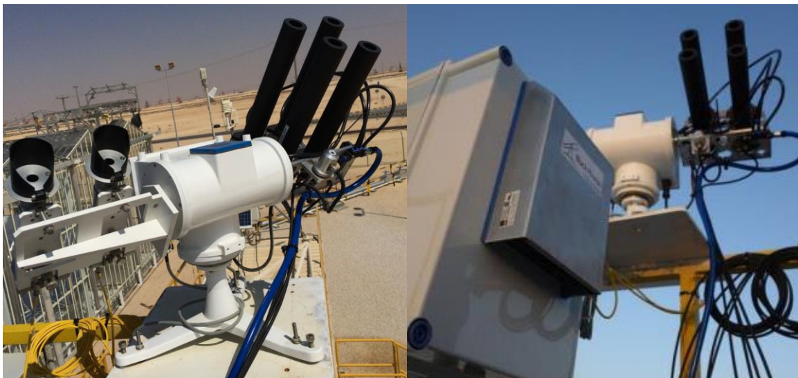
Abbildung 40: Installation an einer DNI- und Circumsolarstrahlungsmessstelle im Oman. Im rechten Bildteil ist die Box zur Filterung der Umgebungsluft zu sehen, die anschließend im blauen Schlauch zu den Sensoren geführt wird.
