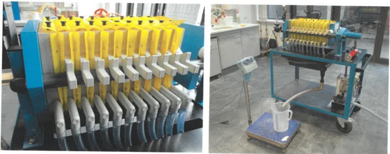
Abbildung 19: links: Laborkammerfilterpresse (LKFP); rechts: Versuchsaufbau mit automatischem Filtratwasserabgabe-Messsystem
