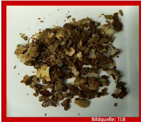
Abbildung 6.11: Trockenes koaguliertes Bentonit, mit Stahl- und Aluminiumelektroden, Versuchsreihe: EMAS-Zelle A
