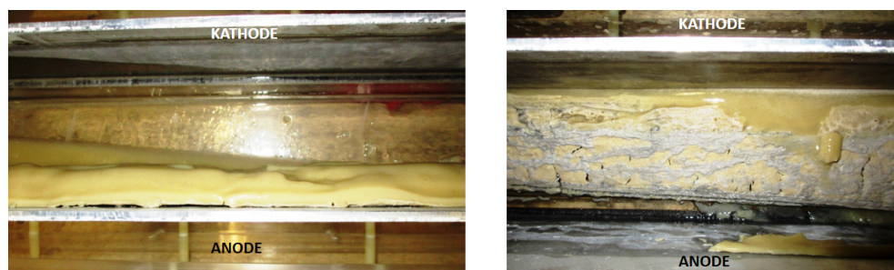
Abbildung 6.34: Bentonitschicht an der Anode, Versuchsreihe: laminare Strömung-Zelle C
