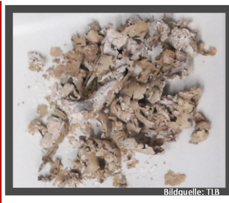
Abbildung 6.11: Trockenes koaguliertes Bentonit, mit Stahl- und Aluminiumelektroden, Versuchsreihe: EMAS-Zelle A
