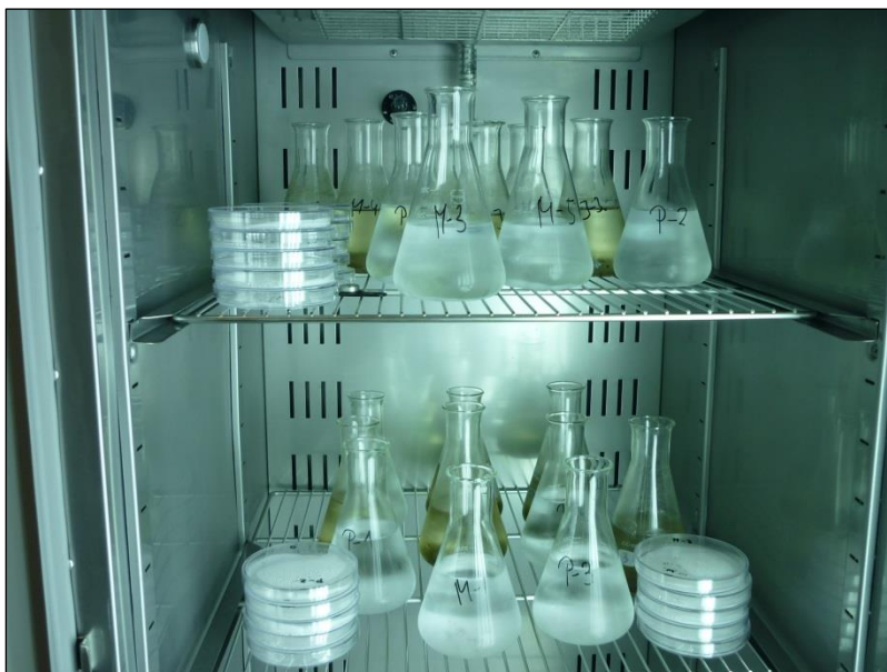
Abb. 11: Keimungsversuche mit Petrischalen und Erlenmeyerkolben in einem der Keimschränke (Foto: M. Brockard).
