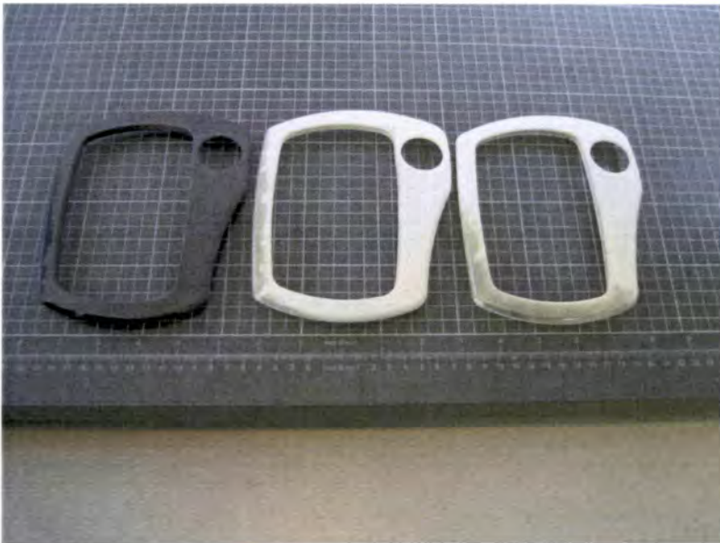
Abb.: 9 Prüfmuster WPC 50 nach 10 Tagen Zerstörung der Lackflächen
