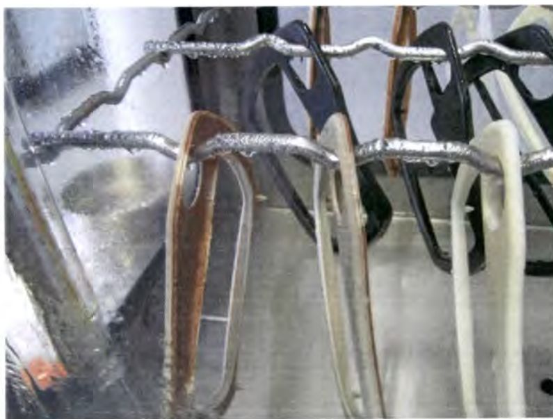
Abb.: 8 Prüfmuster WPC 50 nach 3 Tagen Deutlich sind die Eintrübungen und Verfärbungen zu erkennen. Die Bauteile waren anfangs braun.
