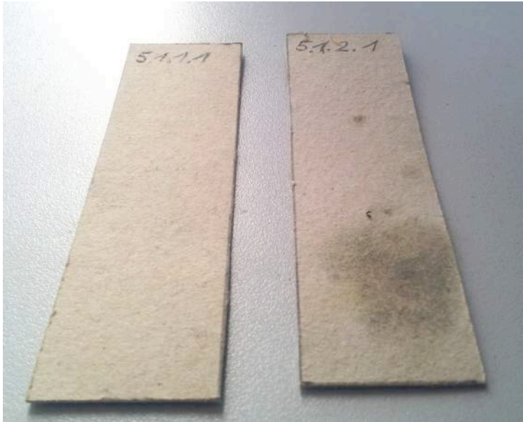
Abb. 9 In Feuerschutzsalz getränkte Pappstreifen nach 30 Wechsellagerungszyklen
