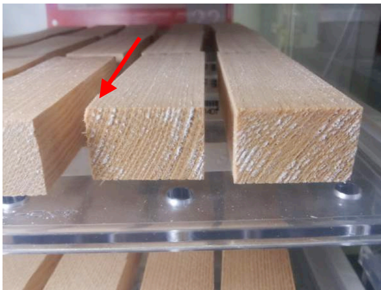
Abb. 8 Ansätze einer Lockerung des Holzgefüges in den Eckbereichen nach dem 44. Wechsellagerungszyklus
