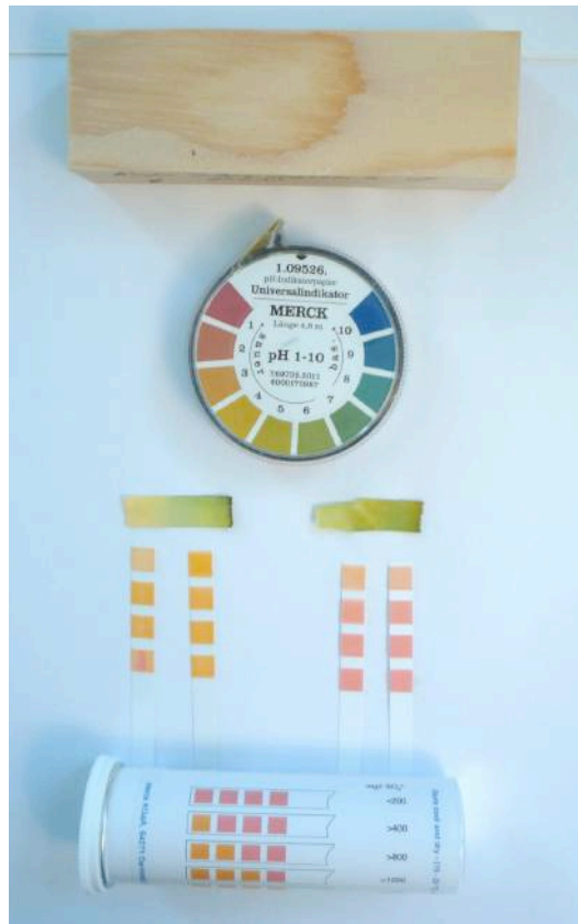
Abb. 14 (rechts) Versuchsergebnis: Teststreifen links auf mit Feuerschutzsalzen behandelte Fläche Teststreifen rechts auf unbehandelte Fläche
