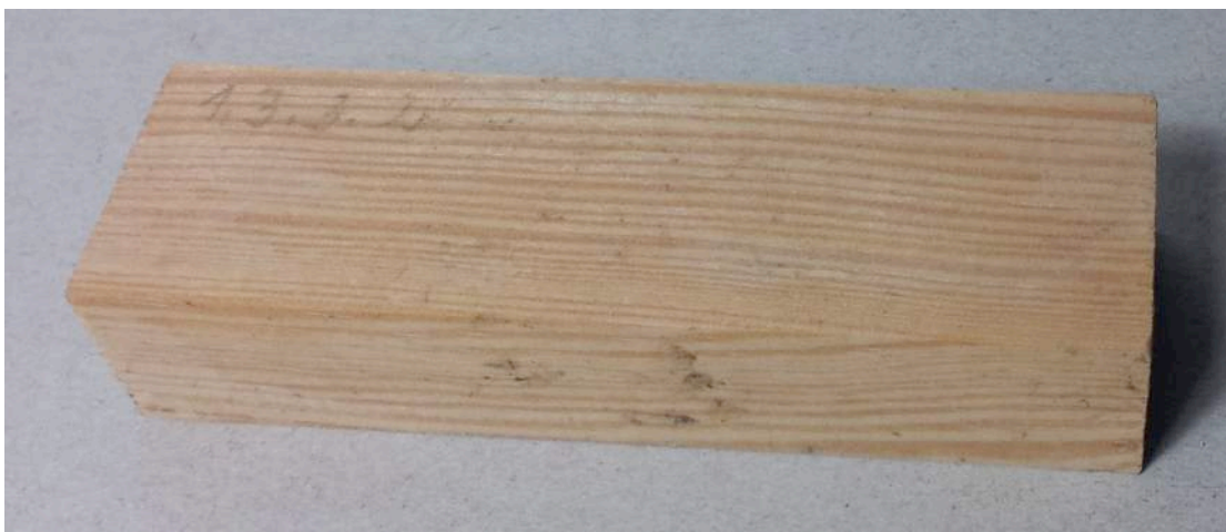
Abb. 10 In gesättigter 1:1 Natriumsulfat- und Ammoniumphosphatlösung getränkte Kiefernholzsplintprobe nach 9 Zyklen der Trocknung und erneuter Tränkung in der Salzlösung
