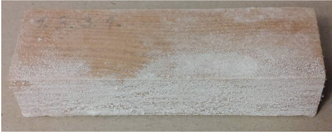
Abb. 11 In 30%iger Feuerschutzsalzlösung getränkte Kiefernholzsplintprobe nach 8 Zyklen der Trocknung und erneuter Tränkung in der Salzlösung
