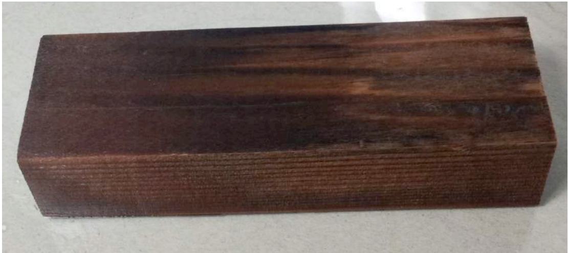
Abb. 12 Fichtensplintholzprobe nach ca. neun Monaten Lagerung der Stirnseite 10 mm tief in 10 %iger Schwefelsäure
