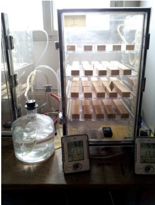
Abb. 7 Der Prüfaufbau zur Erzeugung der hygrischen Wechselbeanspruchung entspricht dem Prüfaufbau zur Untersuchung der Sorptionseigenschaften
