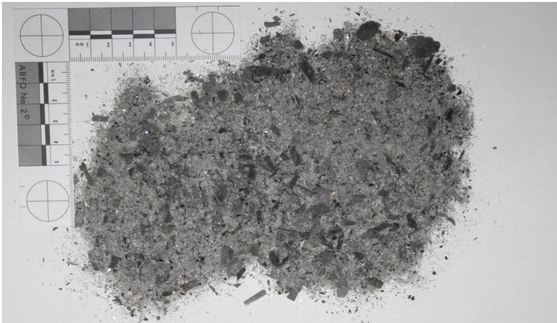
Abbildung 19 Zerkleinerte LCD-Panels nach der ersten Zerkleinerung (Rasenack, Goldmann).
