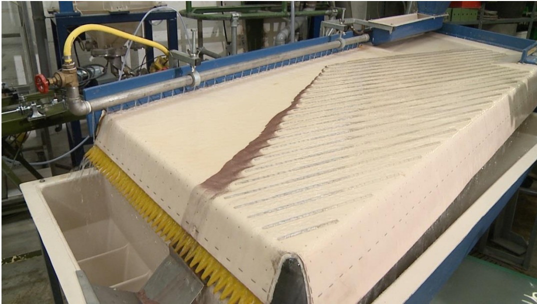
Abbildung 6 Dichtentrennung im wässrigen Medium für Feinstpartikel.
