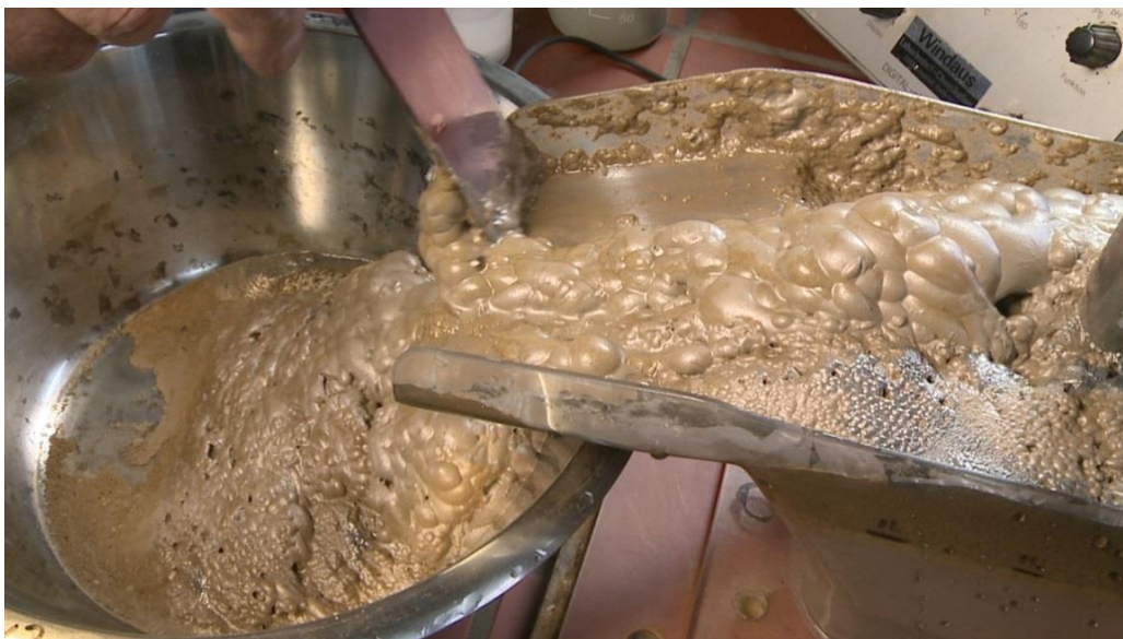
Abbildung 25 Filmsequenz: Anreicherung durch selektive Hydrophobierung des Bleiglanzes und der Zinkblende in zwei Stufen.
