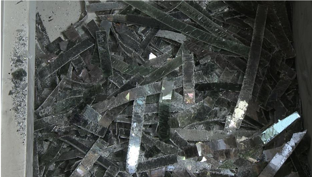
Abbildung 21 Prozessschritte im Film Clip: Zerkleinerung in einer Schneidmühle und in einer Hammermühle – Festlegung eines Siebschnittes – Fällung und Laugung.
