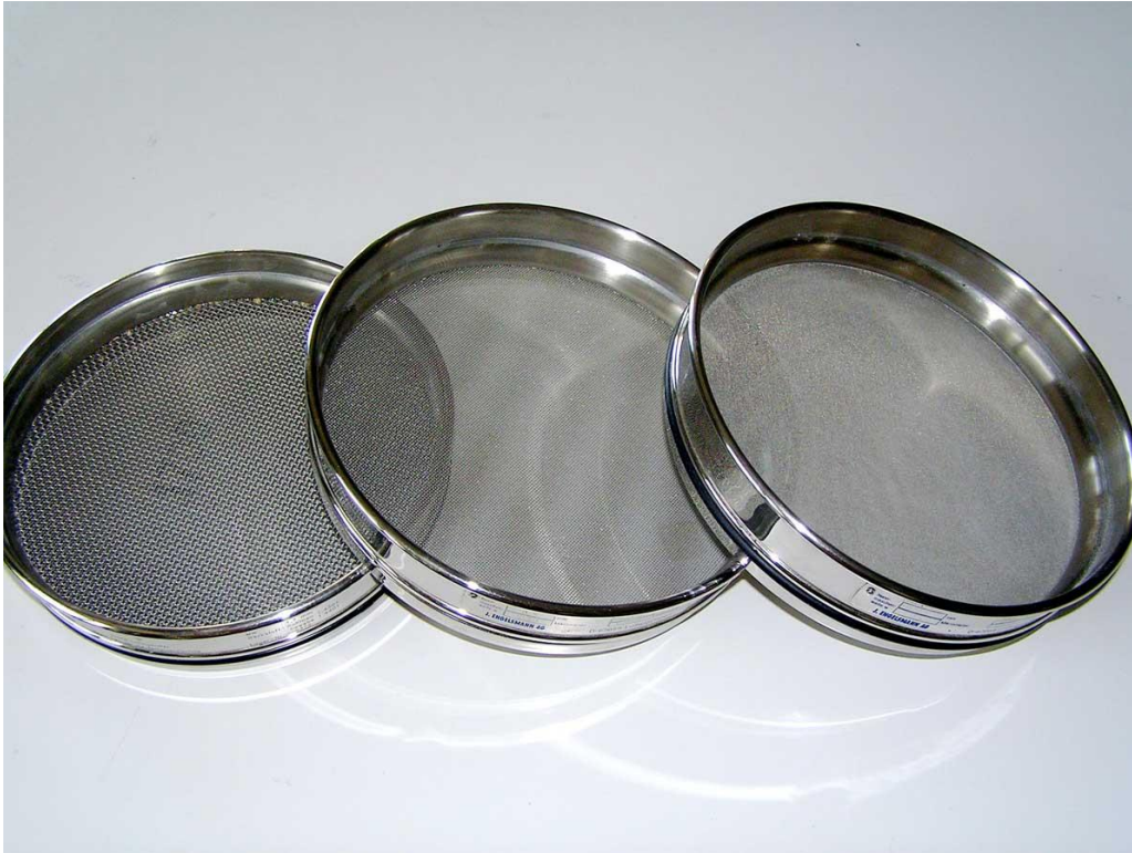
Abbildung 18 Siebe unterschiedlicher Maschenweite übereinander gestellt ergeben einen Siebturm.
