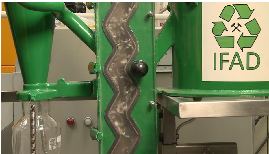
Abbildung 17 Zick-Zack-Sichter zur Trennung von Schwer- und Leichtgut.
