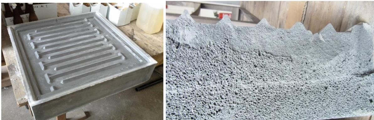
**Abbildung 15: Schaumglas für Prototyp; links: Grundkörper; rechts: Schaumstruktur im Querschnitt**
