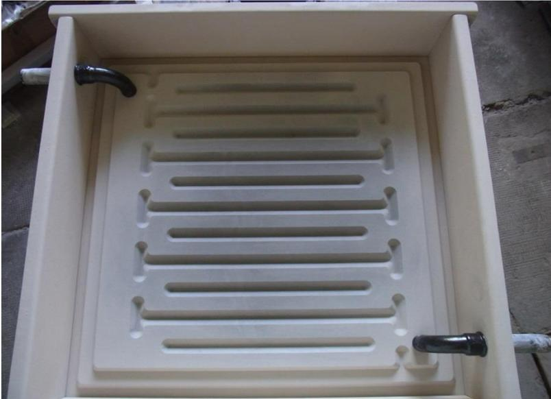
**Abbildung 16: Form mit fixierten Rohrbögen (Blick von oben)**
