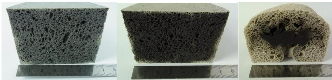
**Abbildung 8: Schaumglasquerschnitte unter Verwendung unterschiedlicher Ruße als Blähmittel**
