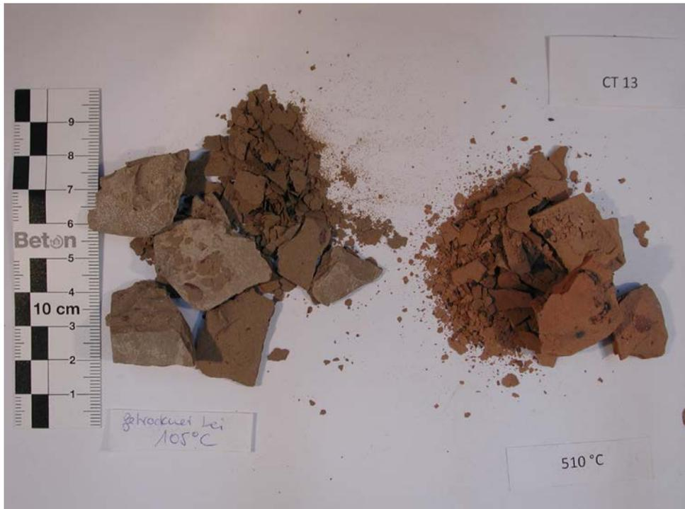
Bild 4: Vergleich von calcinierten Tonen nach einer gezielten Vortrocknung (links) und mit üblichem Ausgangsfeuchtegehalt (rechts)
