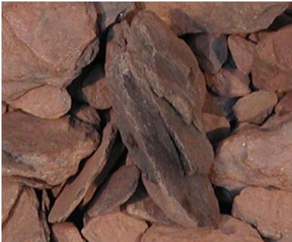
Bild 3: Großtechnisch im Vorversuch hergestelltes Korn mit deutlich unterschiedlich oxidierten Bereichen (Länge des Bildausschnitts im Original: 3 cm)
