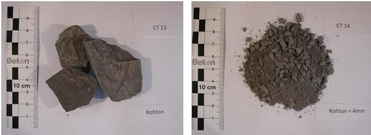
Bild 2: Vergleich der Korngrößen des Rohtons für die Laborversuche
